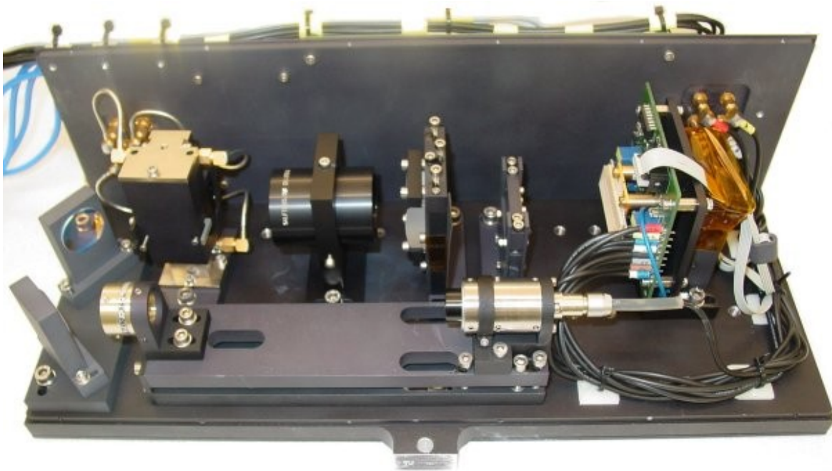
FIGURA 5. Espectrómetro Acusto-óptico de SOFIA (NASA-ESA)
