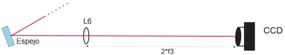
Figura 5.19. Desplazamiento de la cámara CCD para observar la reconstrucción de los anillos de Montgomery a una distancia  $f_3$  desde donde se generó el campo de polarización inhomogénea.
