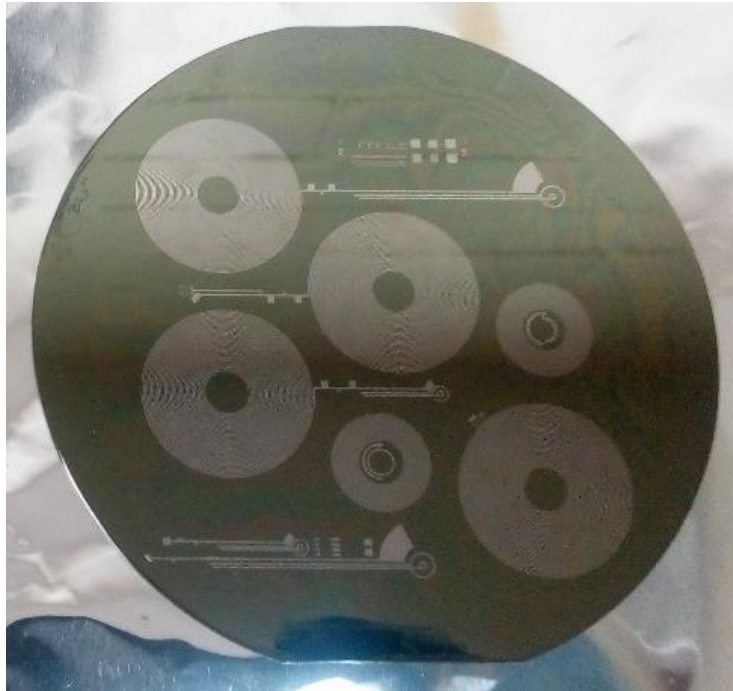
Figura 4.13. Litografía de la mascarilla 1.
