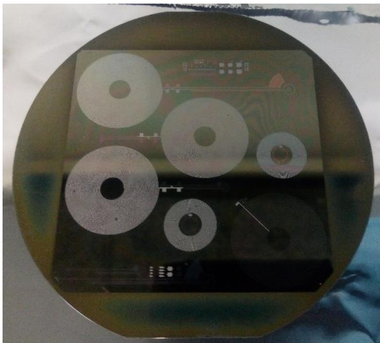
Figura 4.15. Litografía de la mascarilla 3.
