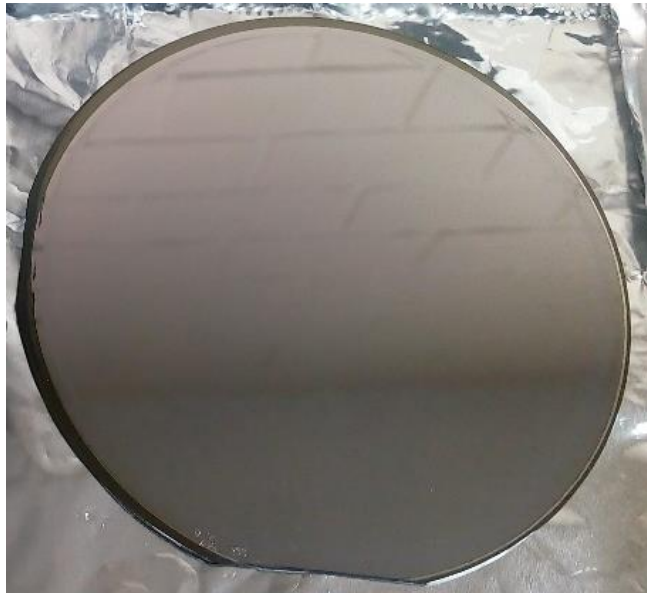
Figura 4.12. Oblea de silicio de 4", con depósito de primer nivel metálico Al/Ti.
