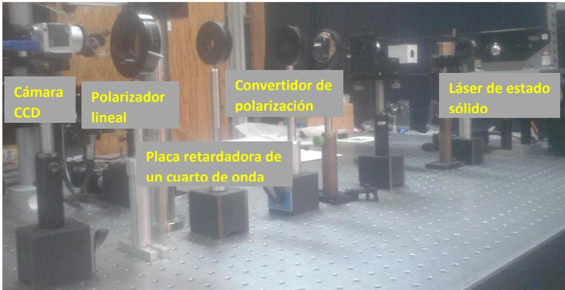
Figura 3.9: Polarímetro de Stokes construido con: 1) Láser de estado sólido de  $\lambda = 532 \text{ nm}$ , 2) un polarizador lineal, 3) una placa retardadora de un cuarto de onda, 4) convertidor de polarización (S-waveplate) y 5) una cámara CCD.
