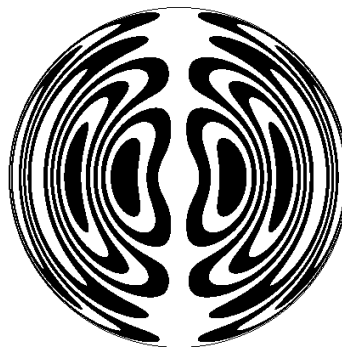
Figura (5.21). Ronchigrama para espejo esférico corregido con cuatro coeficientes.
