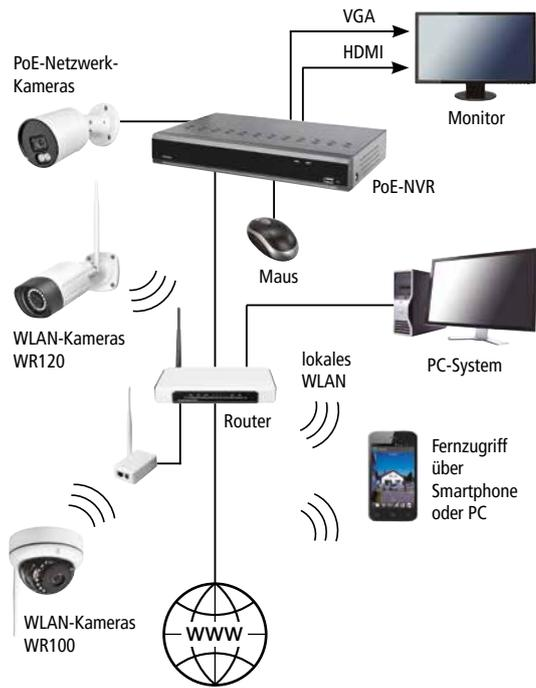
Der direkte Zugriff auf den NVR über PC und Smartphone ermöglicht die Betrachtung von Livebildern und gespeicherten Daten aller angeschlossenen Kameras.
