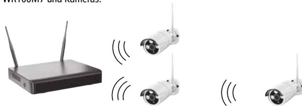
Kamera auch als WLAN\*-Repeater einsetzbar (bis zu 3 Kameras in Reihe)
