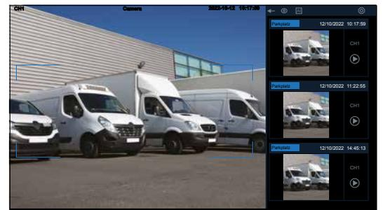
Bei INDEXA Netzwerkcameras mit integrierter künstlicher Intelligenz (KI) können Menschen/Fahrzeuge erkannt werden, um bei Erfassung Aufnahmen zu starten bzw. Benachrichtigungen zu senden.
