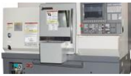
Okuma Genos L200E-M (Ø 0-200mm) w/feeder.
