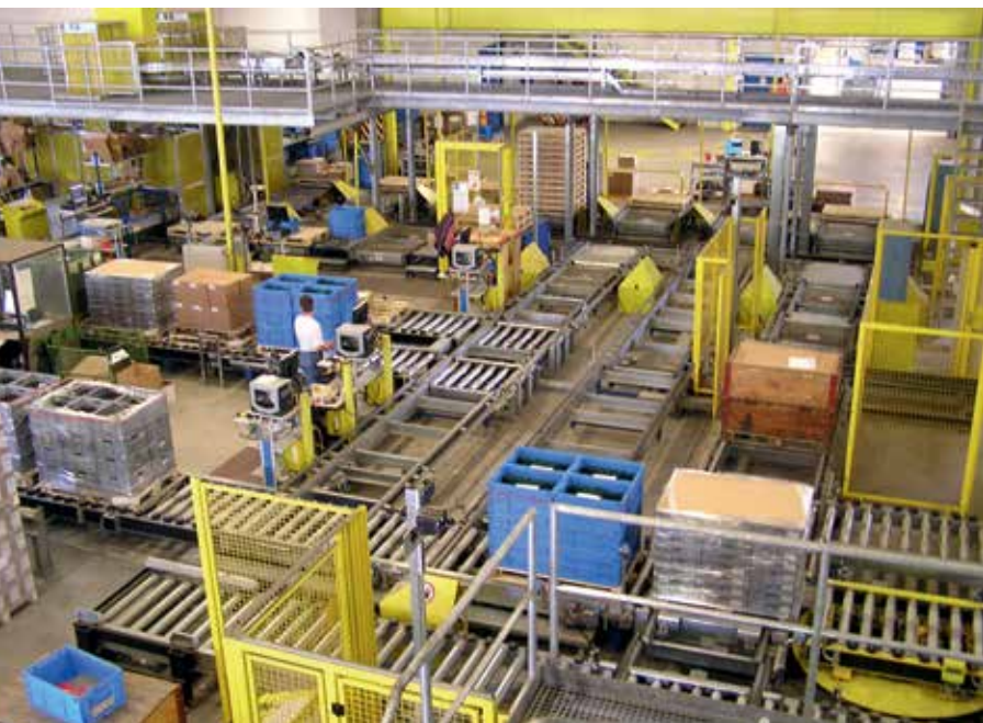
Bild 3: Über Verschiebewagen wird die Ware verteilt.
