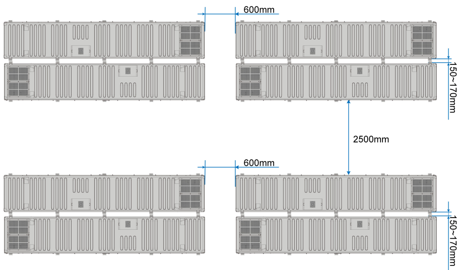
图 4-3 多个设备安装 (4*BESS)
