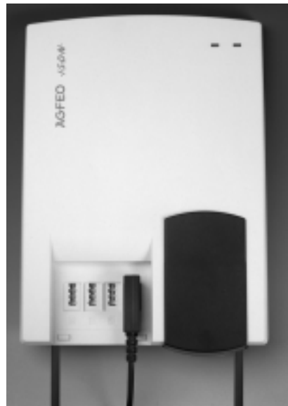
Abb. 4: TK-Anlage mit gesteckter Stromversorgung, ISDN-Anschluss und TAE-Stecker
