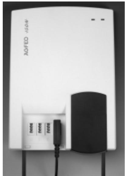
Abb. 4: TK-Anlage mit gesteckter Stromversorgung, ISDN-Anschluss und TAE-Stecker
