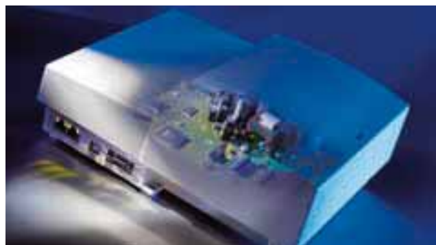
SCHNITTSTELLE: Über die Telefonanlage AS 45 von Agfeo wird die Gebäudeautomation bedient.
