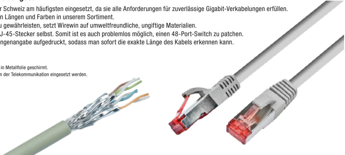
S/FTP, Cat.6 doppelt geschirmt, aus 100 % Kupferleiter und halogenfreiem Mantel bestehende Patchkabel mit besonders schmalen RJ-45 Steckern mit Längenaufdruck
