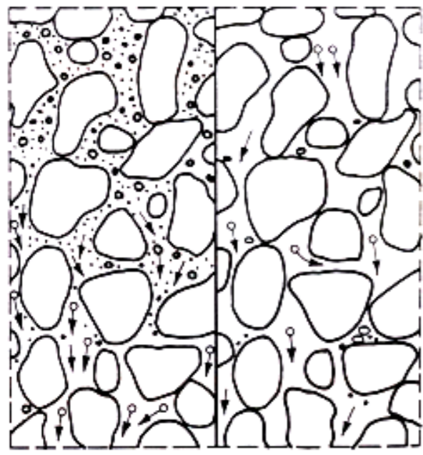
Abbildung 10 Suffosion – feine Bodenkömer bewegen sich in Poren der größeren Bodenkömer
