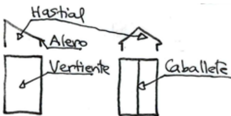
Fig. 16 Cubierta a un agua
