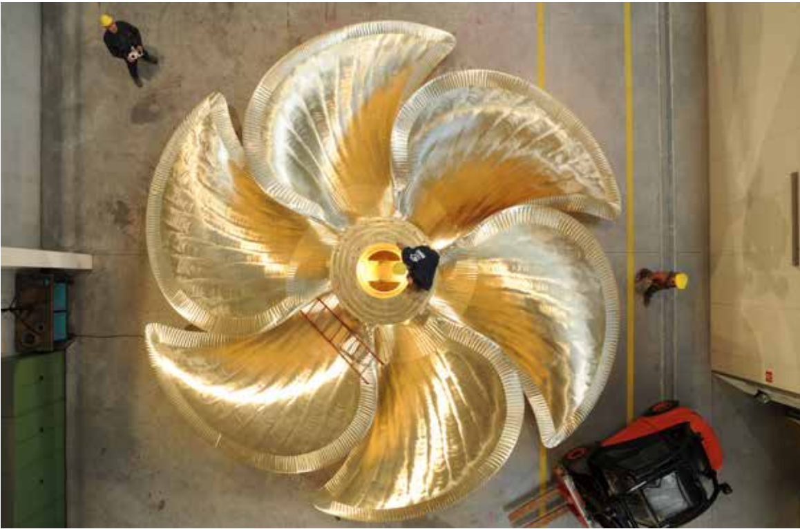
5. Hélice de navire en CuAl10Ni5Fe ayant un diamètre de 11.4 m. A noter la couleur jaune claire due à l'adjonction d'aluminium ainsi que les traces de la refusion de la surface par laser.
