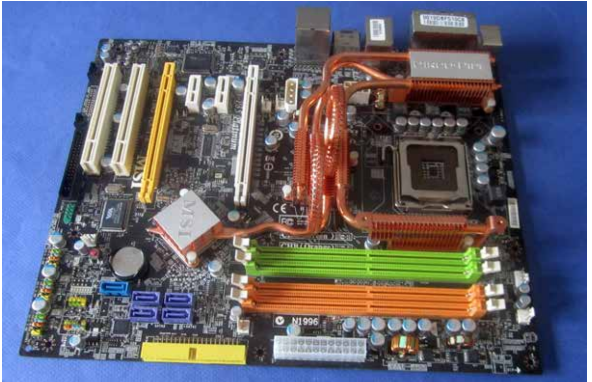
2. Carte mère d'ordinateur. Pour les générations récentes, la majeure partie du cuivre est contenue dans les caloducs et radiateurs servant à évacuer la chaleur générée dans les composants électroniques.
