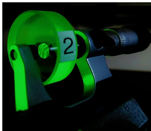
Figura 5 Paralelas ópticas y franjas de interferencia
