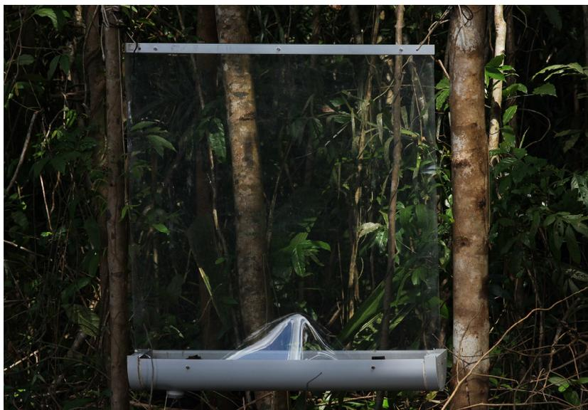
Piège à interception vitrés en lisière et insectes dans gouttière (ci-dessous).
