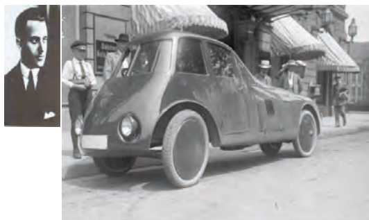
Figura 9.10 Aurel Perșu (1890 - 1977), inginer mecanic, a realizat în 1923 primul automobil aerodinamic din lume (foto Pahl, Georg, iulie 1923)
