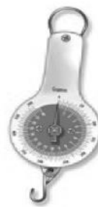
Dinamómetro a base de resorte de torsión.
