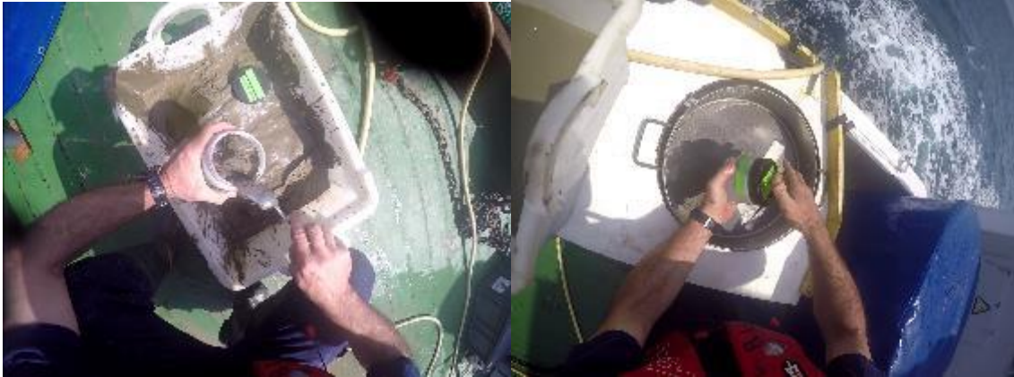
Figura 3.2.3.1. Secuencia de toma de muestra de sedimento: largado de la draga, vaciado de la draga, recogida de muestra de sedimento y almacenamiento.
