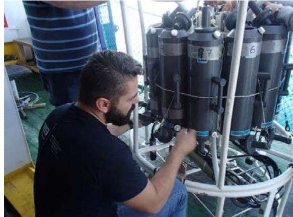
Figura 12. Laboratorio multidisciplinar desde donde se realiza el control de la roseta en la metodología tow-yo (izq.) y preparación de las botellas Niskin para la toma de muestras de agua (dcha.).
