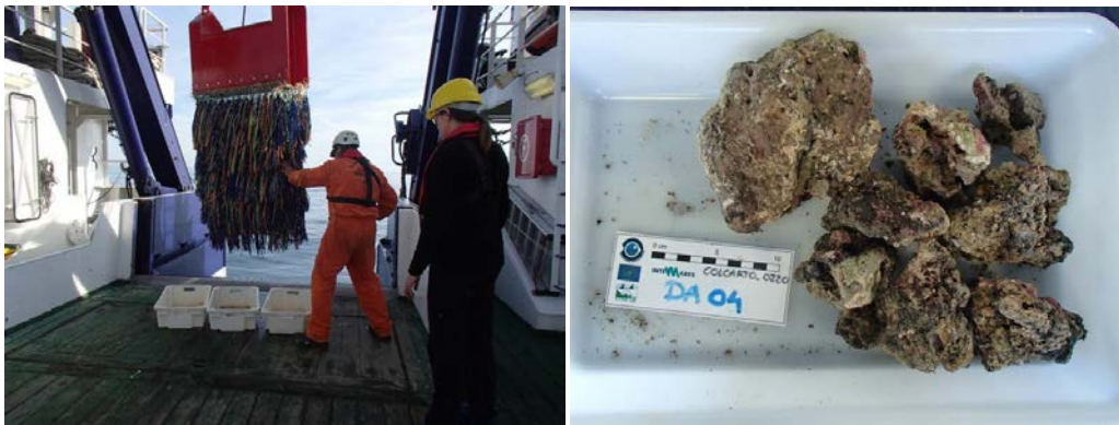
Figura 9. Dragas de arrastre bentónico utilizada durante la campaña COLCARTO_0220 para la recogida de muestras de rocas del fondo marino (izq.) y ejemplo de muestras de rocas obtenidas (dcha.).
