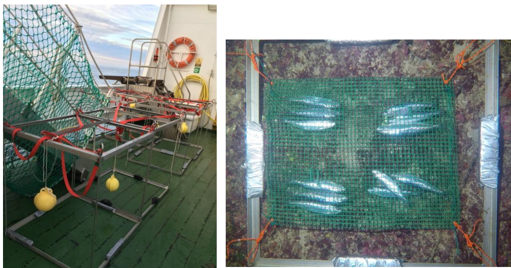
Figura 17. Estructuras de vídeo cebado (LoVE) utilizadas durante la campaña COLCARTO_0220 para la obtención de imágenes submarinas (izq.) y canister con cebo (dcha.).
