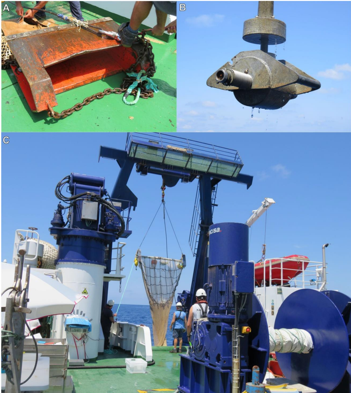
Figura 4. Equipos de muestreo utilizados en la campaña INTEMARES-A22B_0718: A) draga de arrastre; B) draga Shipeck; y C) patín epi-bentónico.
