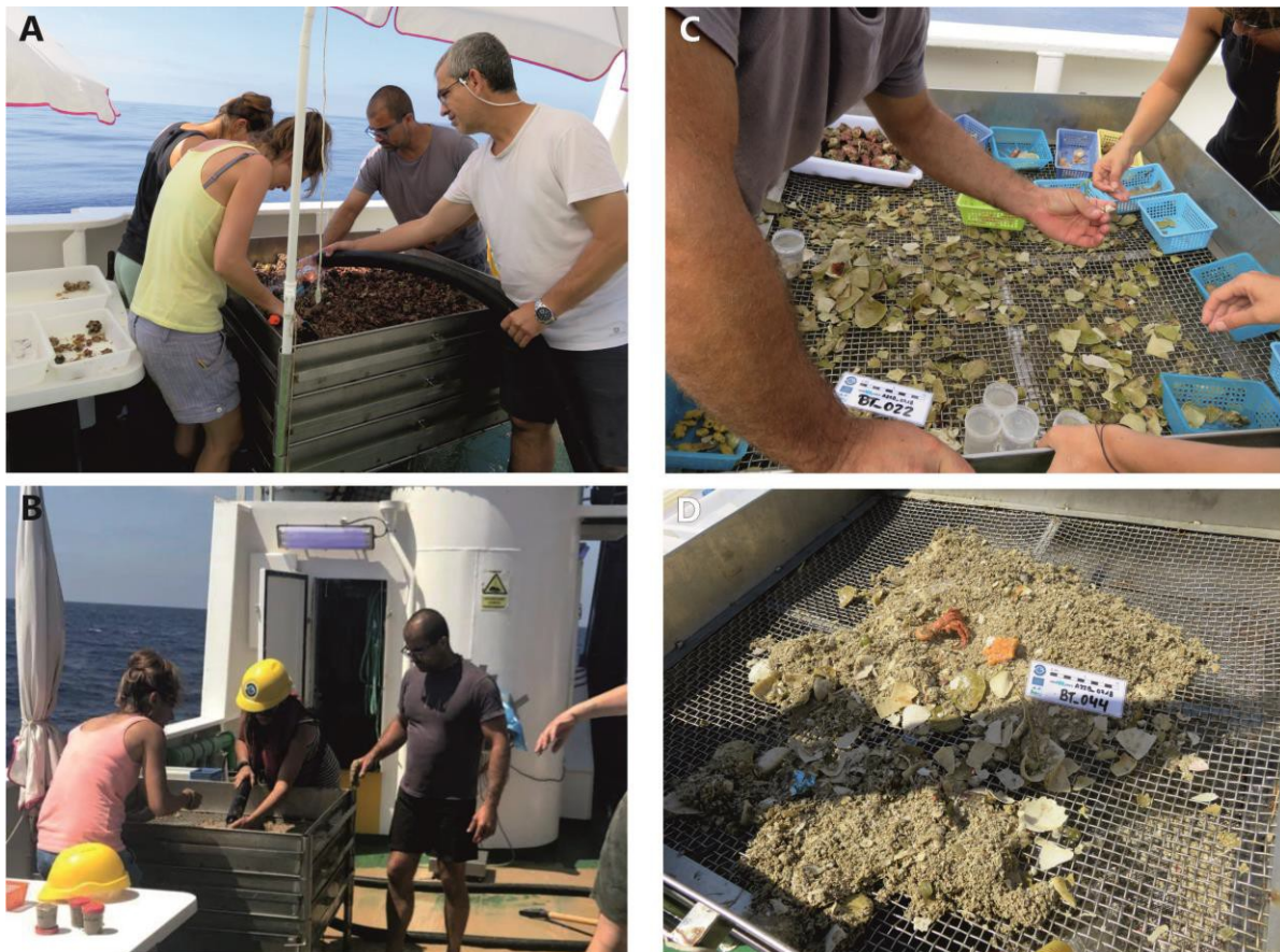
Figura 8. Procesado de las muestras obtenidas con patín epi-bentónico durante la campaña INTEMARES-A22B_0718: A-B) equipo científico trabajando en cubierta con la mesa de tamizado, para el lavado y triado de las muestras; y C-D) muestras lavadas y triadas, de fondos de cascajo, con fragmentos de bivalvos y ejemplares de flora fauna separados en bandejas clasificatorias y botes de muestras.
