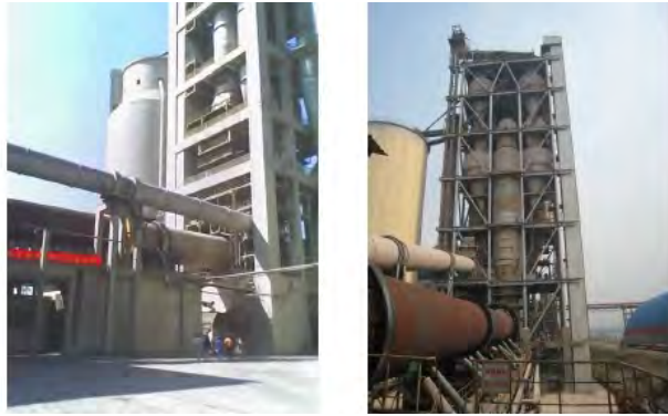
有预热器和分解炉的回转窑，示例图片来源于某中国水泥厂。
