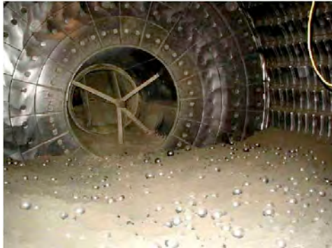
水泥磨中的熟料和钢球，Castle Cement 免费提供，摘自 http://www.understanding-cement.com/mill.html 。
