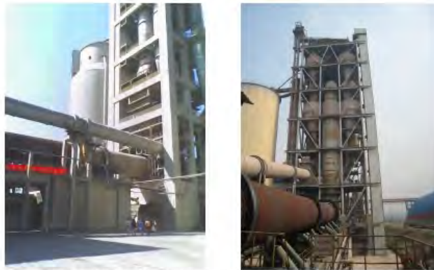
有预热器和分解炉的回转窑，示例图片来源于中国某水泥厂。
