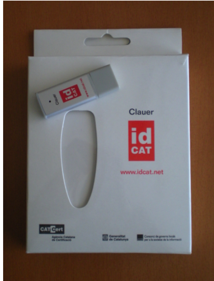
FIGURA 1.24. Clauer idCAT: llapis de memòria que conté la identificació electrònica d'un usuari
