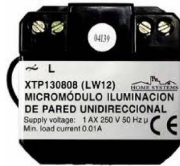
FIGURA 1.19. Mòdul de llum de paret o sostre XTP 130808
