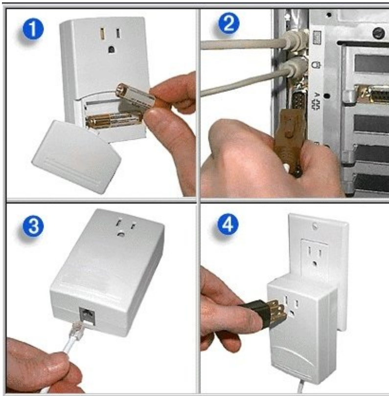
FIGURA 2.1. Passos que cal seguir per posar en marxa el mòdem X-10
