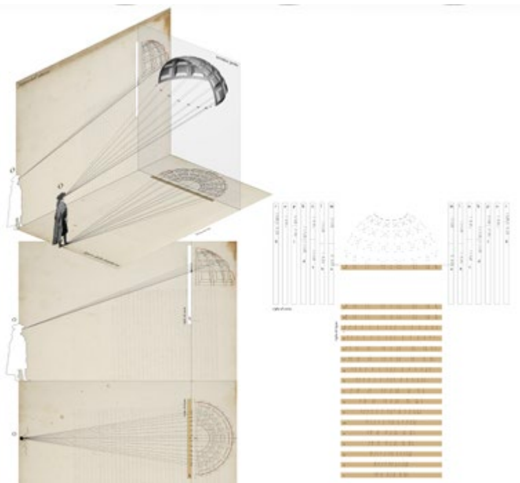
Figura 5. Ricostruzione delle dimensioni del catino absidale e costruzione della prospettiva dei vertici dei lacunari con le righe di legno e le righe di carta sulla base di una distanza principale pari a 10 braccia.
