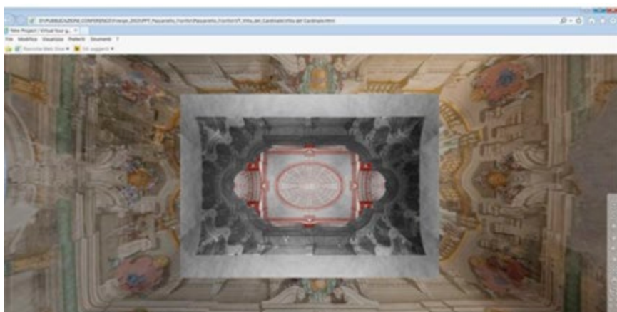
Figura 4. Tour virtuale navigabile da browser, vista della volta del salone con in overlay la ricostruzione virtuale dello spazio dipinto
