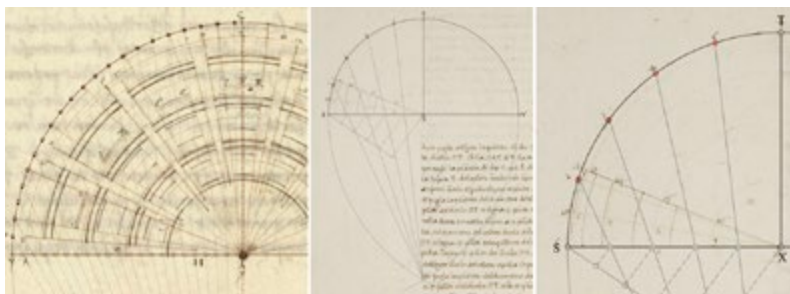
Figura 3. Ricostruzione spaziale dell'impostazione delle dimensioni dei lacunari della cupola.
