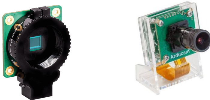
Figura 4.7: High Quality Camera 12Mpx di Raspberry inc. (a sinistra) e Ultra Low Light Camera 2Mpx della Arducam (a destra).
