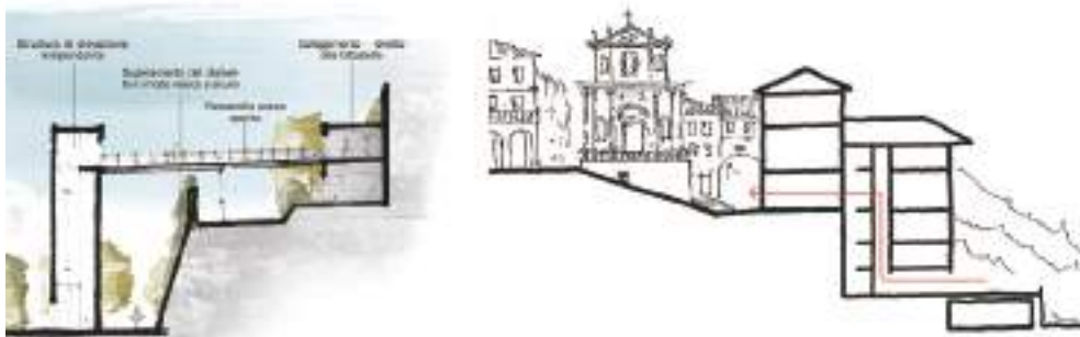
Fig.05 I due ascensori urbani nei progetti per la Cittadella (a sinistra) e nell'edificio dell'ex-Tribunale (a destra).
