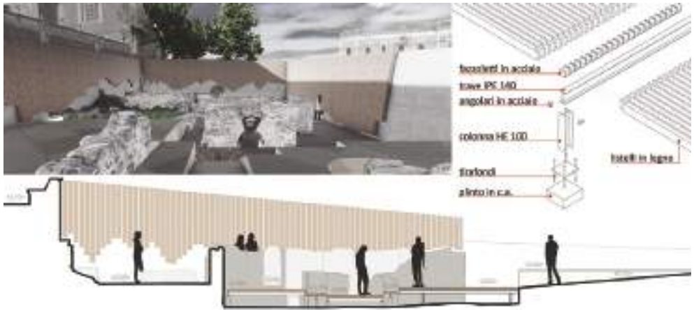
Fig.06 Il Balneum di piazza Dante: Render e sezione trasversale. A destra soluzione costruttiva per il nuovo piano di calpestio da porre alla quota dell'originario pavimento romano (La Rosa, 2020).
