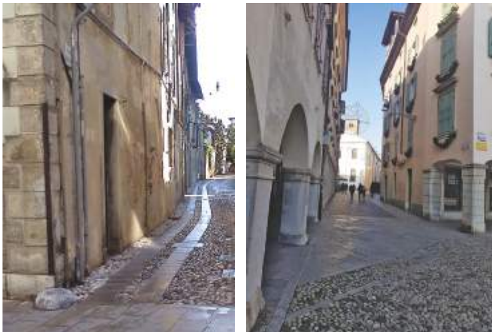
Fig.01 Centro storico di Udine, Italia. Esempio di pavimentazione accessibile realizzata con tipi tradizionali lapidei lavorati superficialmente e posati con tessitura riconoscibile. Christina Conti
