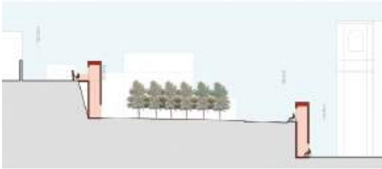
Fig.05 Erice. Nodo di scambio parcheggio – percorsi pedonali, ascensori urbani. Elaborazione arch. Chiara Stabile.
