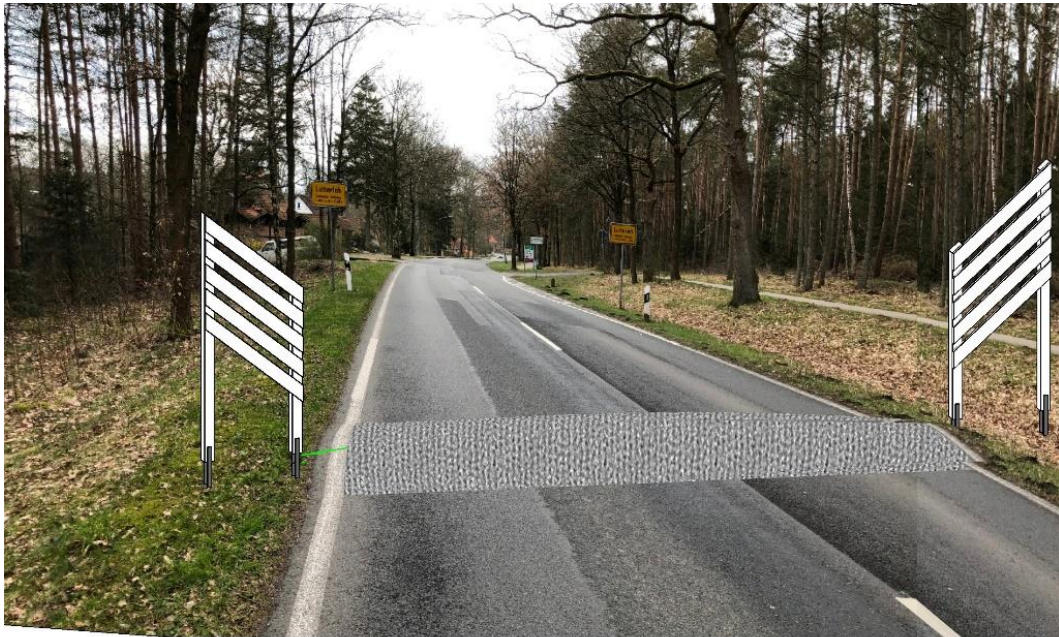
Abbildung 5: Beispiel optische Verengung Lutterloh West. Quelle: cb-plan
