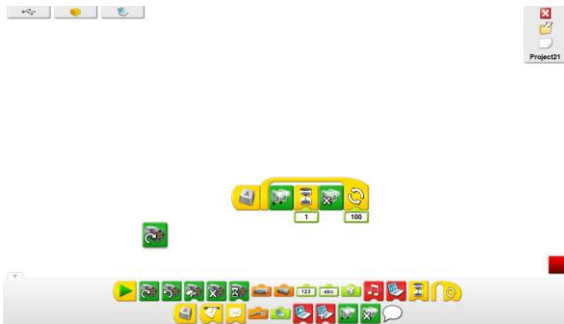
Slika 6. Branje blokovnega programiranja poteka od leve proti desni. Če ukaz ni pravilno postavljen, se ne izvede.
