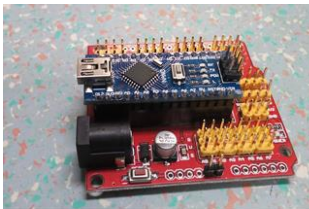
Slika 4: Razvojna plošča Arduino Nano
