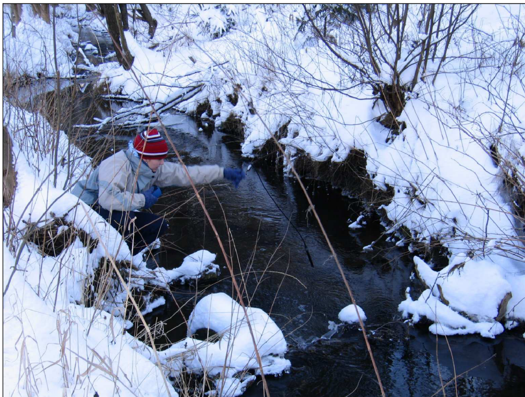
Rožínka - měření průtoku stopovačem (foto autor)
