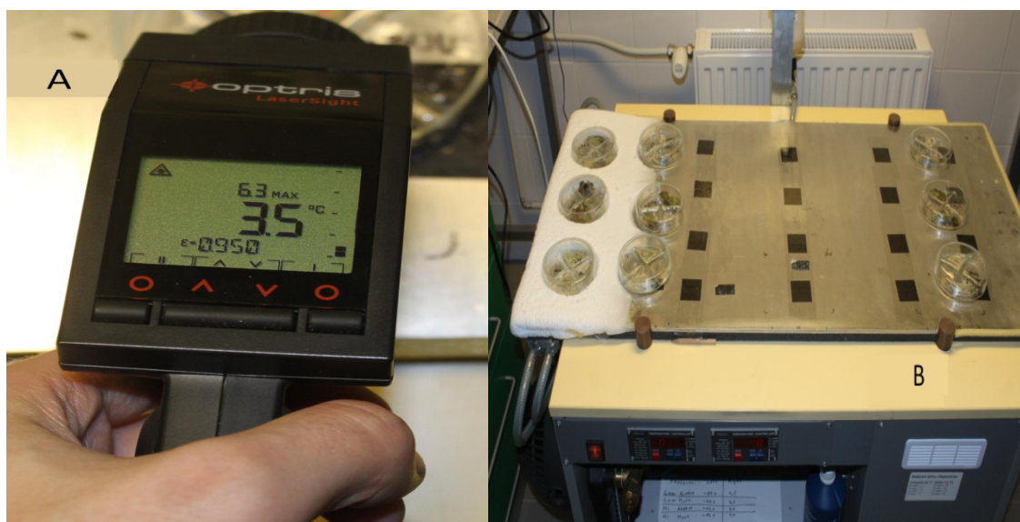
Obr. 14: Pohled na digitální infrateploměr, pomocí kterého byla kontrolována teplota chladicí desky, respektive vzorků – A, Celkový pohled na chladicí desku gradientového kultivátoru – B. Vzorky uspořádané v levé části desky byly chlazeny na teplotu -10 °C, prostřední vzorky na teplotu 0 °C, vzorky v pravé části desky na teplotu 5 °C.
