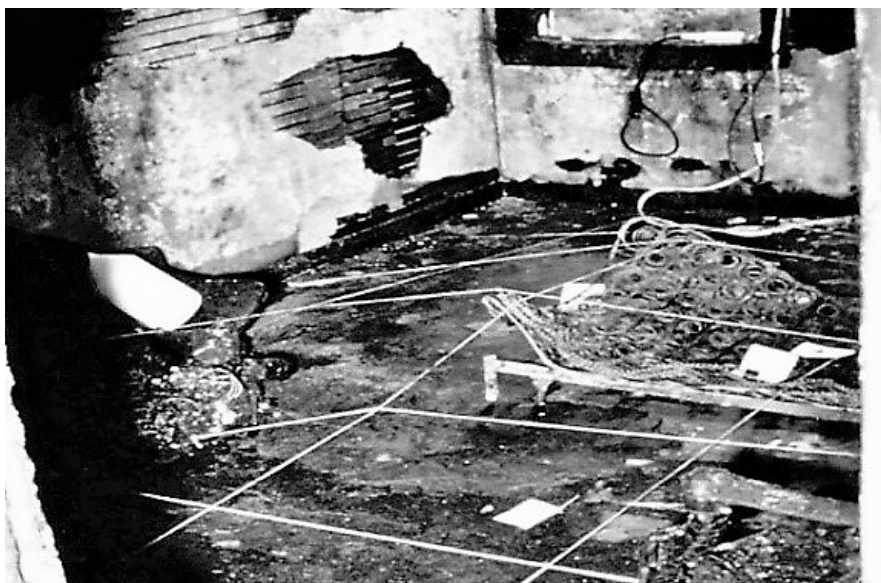
Obrázek 7 – Rozdělení prostoru požářiště na jednotlivé úseky pomocí provázku. Zdroj: NFPA 921 Guide for Fire and Explosion Investigation, 2008 Edition.
