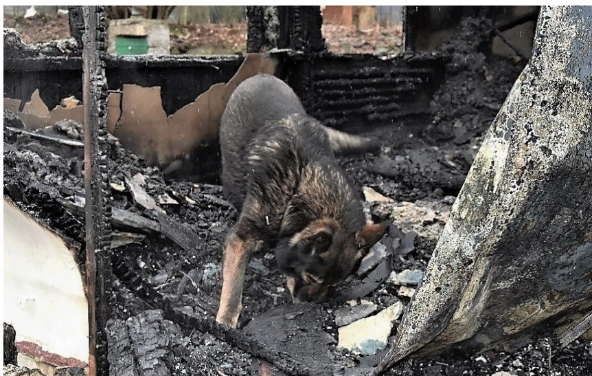
Obrázek 6 – Služební pes při vyhledávání akceleraantů hoření v prostoru požářiště. 15 Zdroj vlastní.
