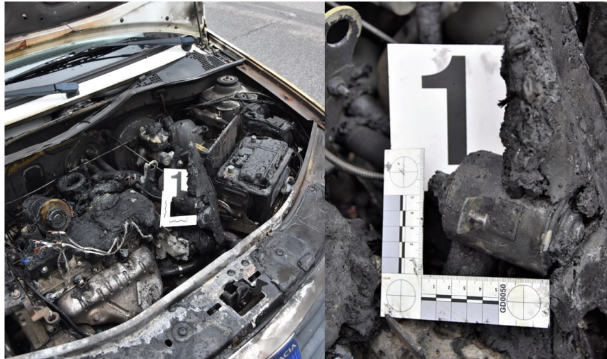
Obrázek 8 – Přiložené měřítko s číslicí u stopy / vzorku v prostoru požárního / kriminalistického ohniska. Zdroj vlastní.
