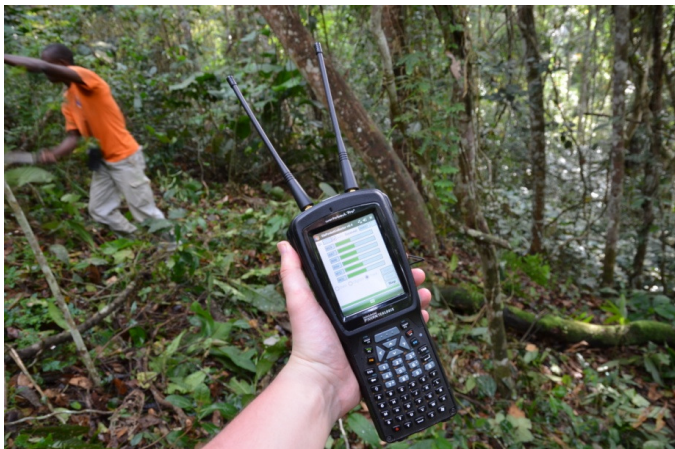
Détection et téléchargement des données issues des colliers sur PAD.
