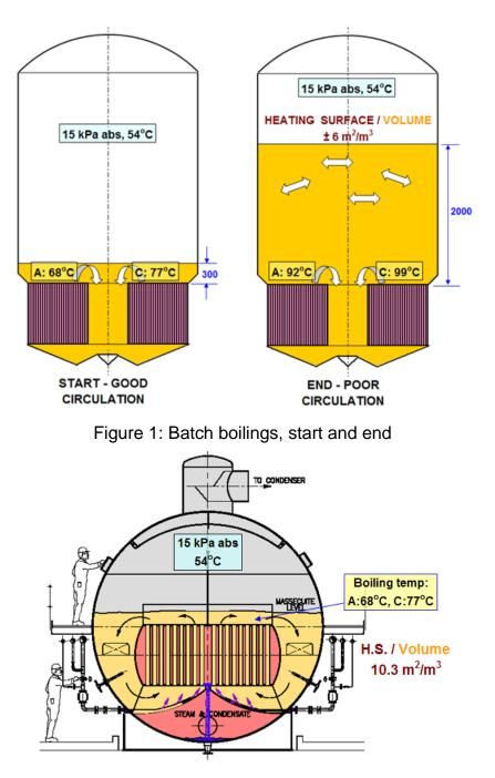
Figure 2: Continuous pan boiling (Bosch)
