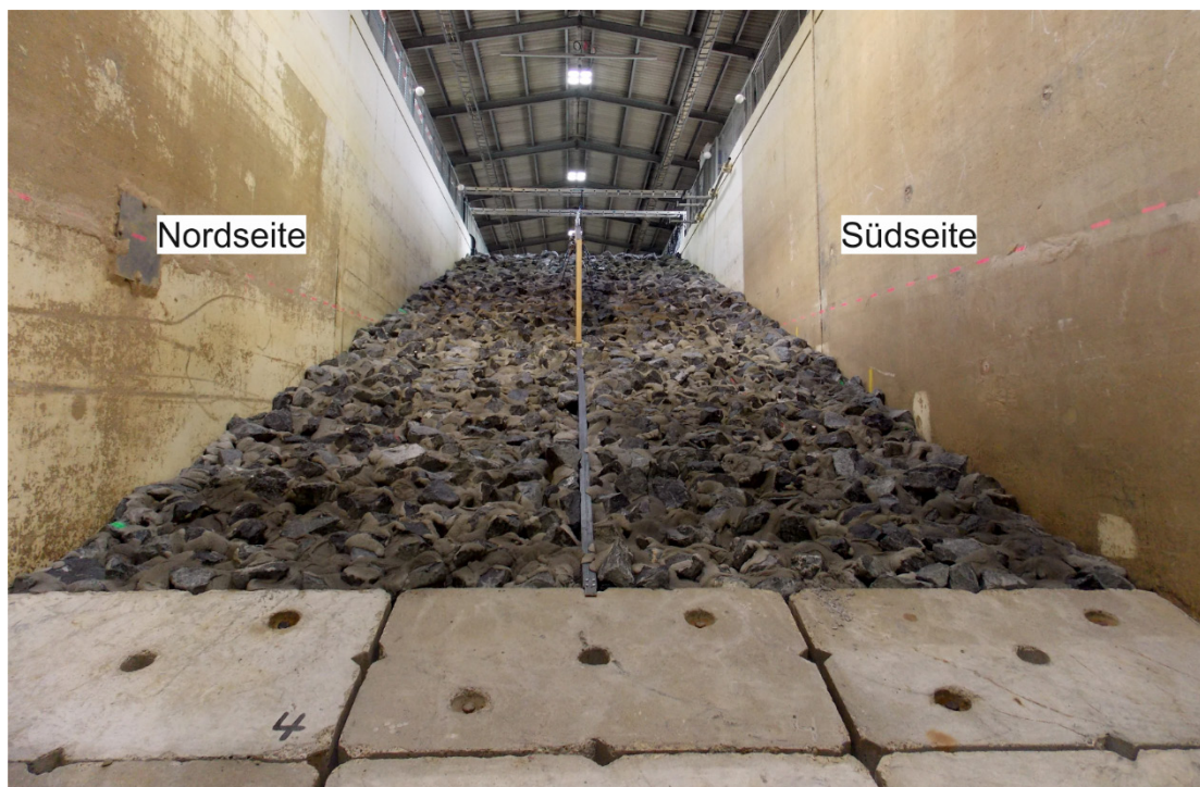
Abbildung 9: Teilvergossene Deckschichten in Versuchsphase 1 (Foto: Kühling 2017).
