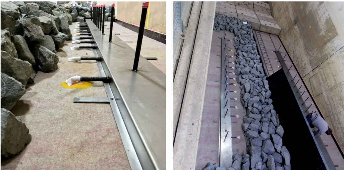
Abbildung 13: Druckmessdosenkanal in der Deckschicht (Fotos: Kreyenschulte 2017).
