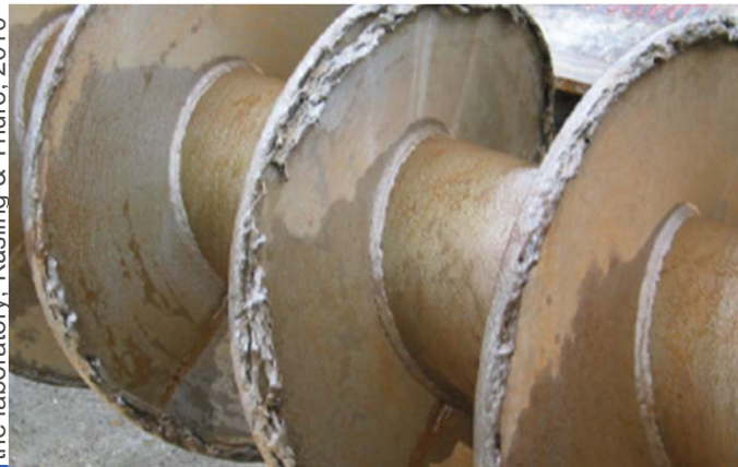
Abrasiivität in der Großbohrtechnik, Bauer Spezialtiefbau & Thuro,
