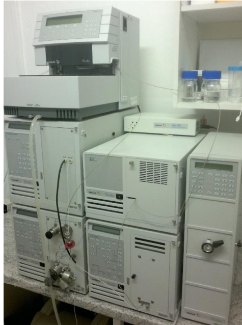
Slika 3.2.4.1. Tekućinski kromatograf visoke djelotvornosti (Varian) sastavljen od modula za uklanjanje plinova iz mobilne faze, UV/Vis detektora, detektora s nizom diode, fluorescentnog detektora, kvaterne pumpe i automatskog uzorkivača.
