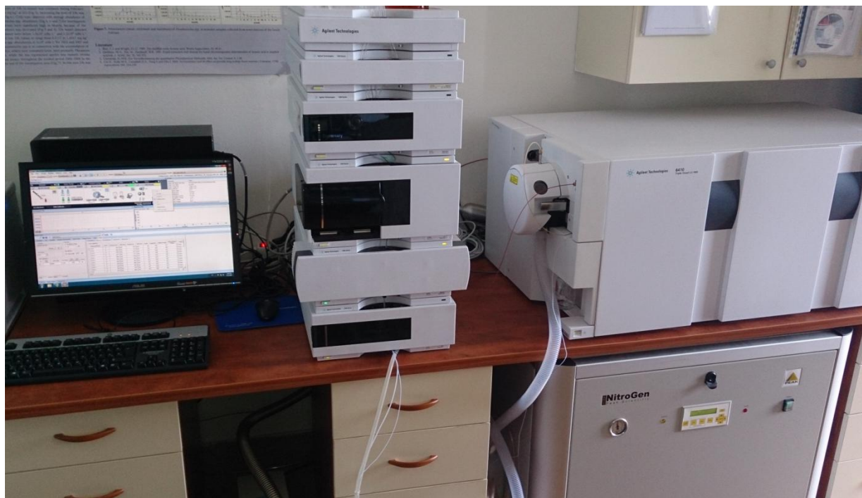
Slika 3.2.4.9. Vezani sustav tekućinski kromatograf i maseni spektrometar, Agilent Technologies: trostruki kvadrupol - Triple Quad 6410, odzračivač - Degasser 1200, kvaterna pumpa - Quaternary Pump 1200, automatski uzorkivač - Auto sampler 1290 i termostatirano kućište za kolonu - Thermostatted Column Compartment 1290.
