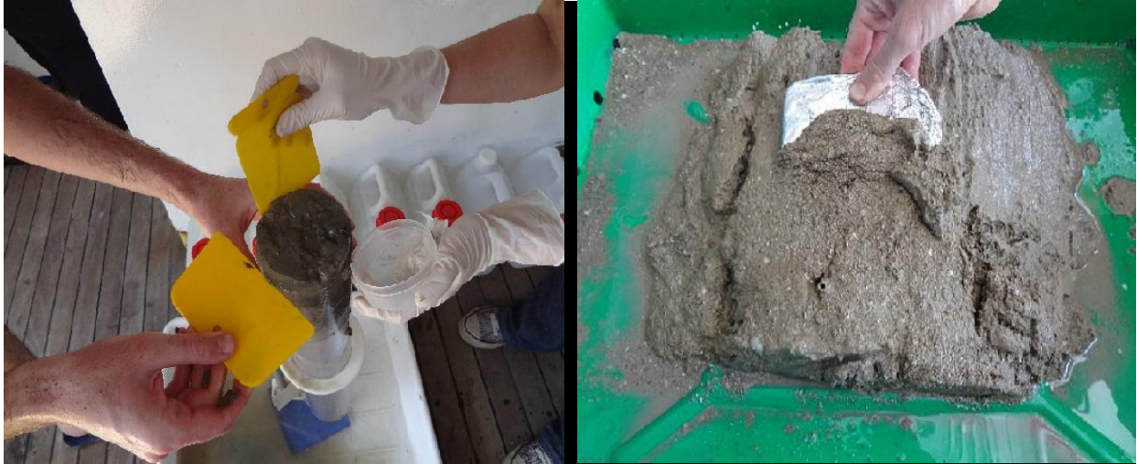
Slika 3.2.2.2. Uzimanje površinskog sloja sedimenta za analizu sadržaja teških metala i kloriranih ugljikovodika.
