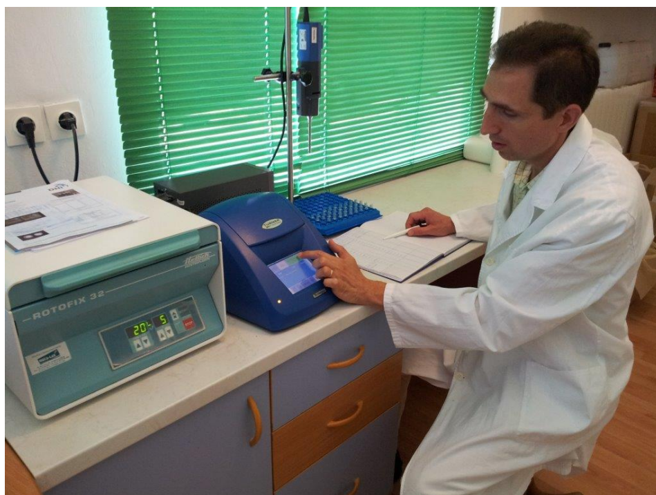
Slika 3.3.1.3. Uređaji koji se koriste za određivanje koncentracije klorofila a: centrifuga, Turner fluorometar i homogenizator.
