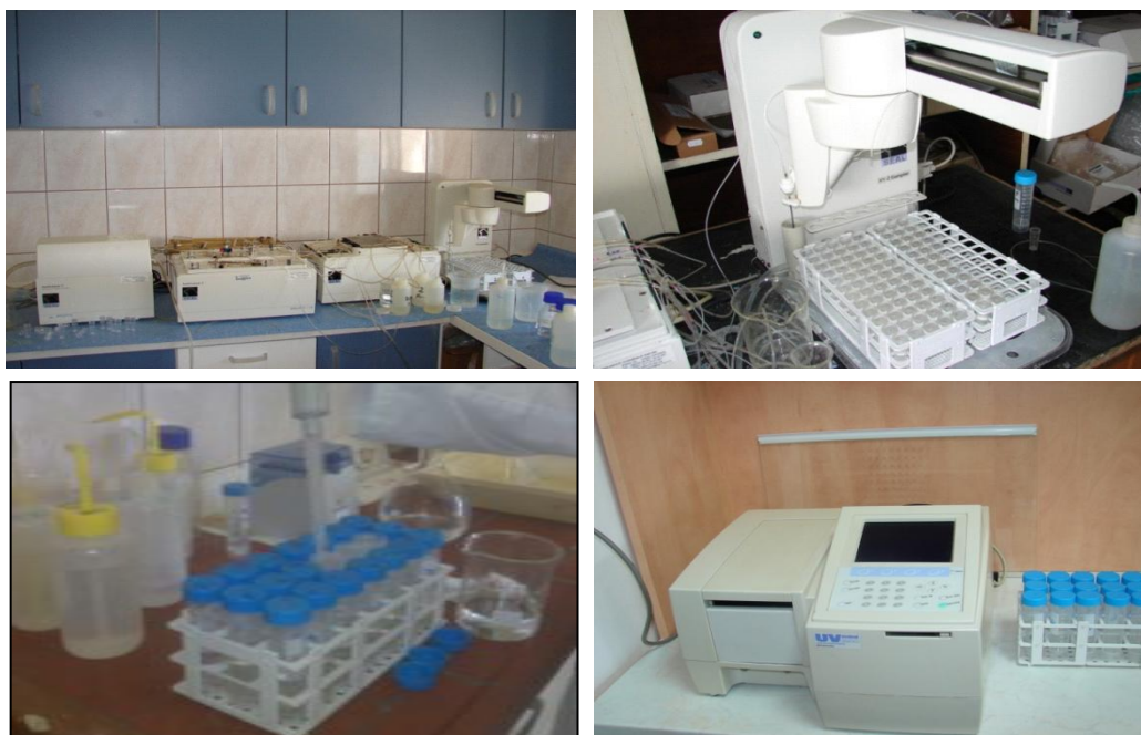
Slika 3.2.1.4. Određivanje hranjivih soli na „AutoAnalyzer-u III“ te na za spektrofotometru Shimadzu UV mini 1240.
