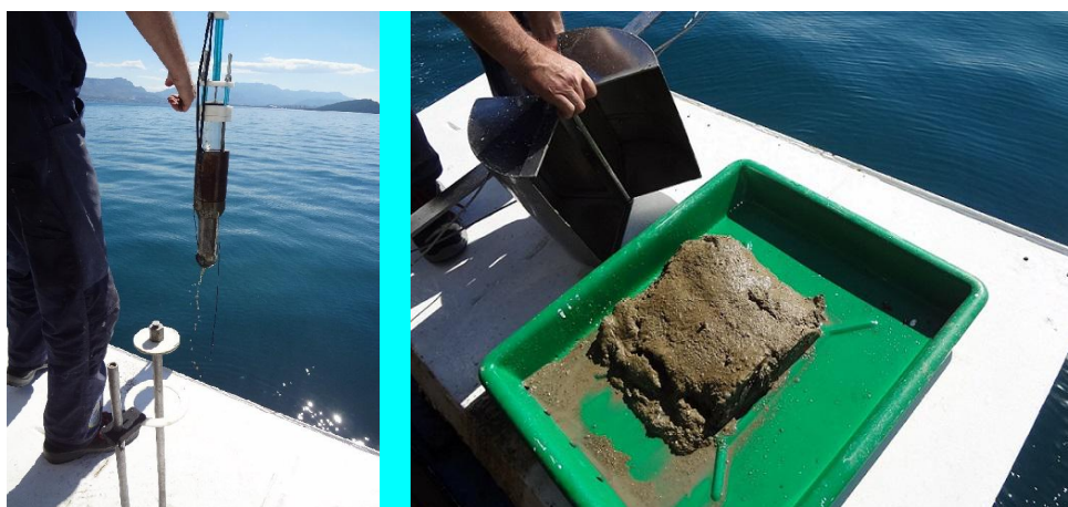
Slika 3.2.2.1. Uzorkovanje sedimenta plastičnim gravitacijskim korerom te Van Veenovim metalnim grabilom.
