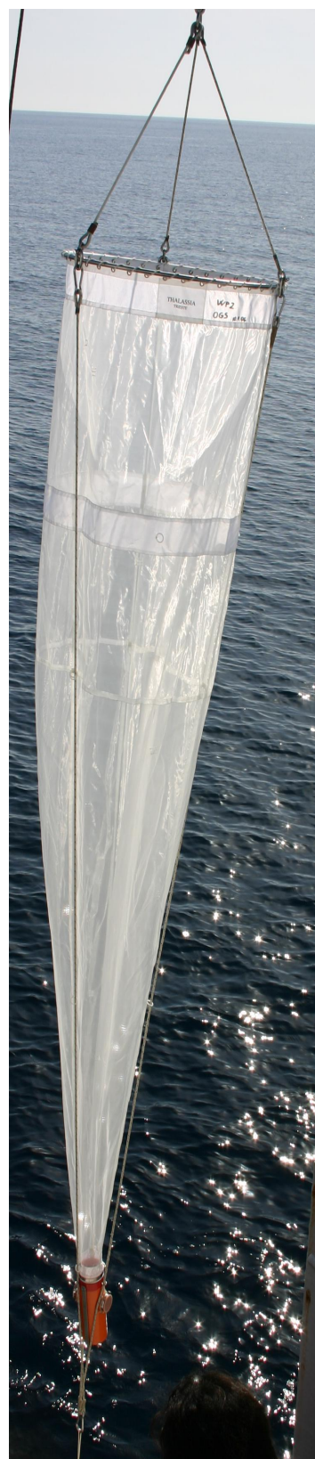
Slika 3.4.2.1. Shematski i fotografski prikaz standardne planktonske mreže WP2 kojom će se prikupiti uzorci ihtiopleačijala
