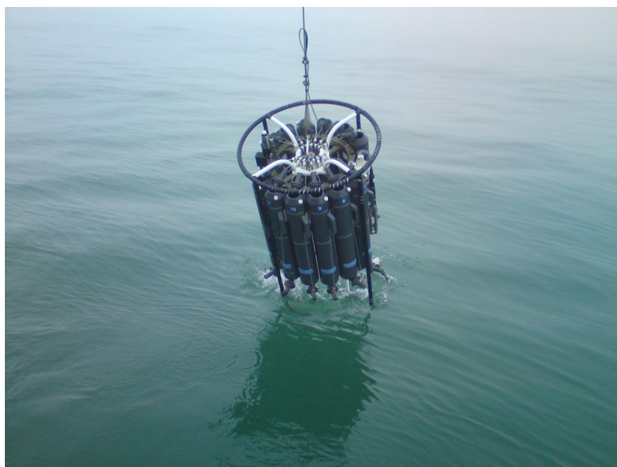
Slika 3.1.1.3. Mjerenje višeparametarskom sondom na rozeti sa crpcima
