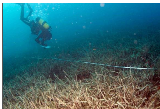
Slika 3.3.4.6. Određivanje pokrovnosti podloge izdancima vrste Posidonia oceanica pomoću LIT metode
