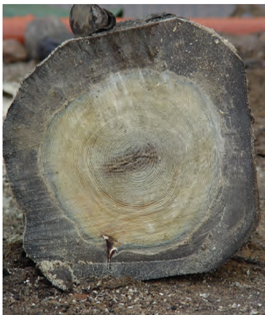
FIGUR 73. Snabbvuxet timmer från kistkonstruktion.
