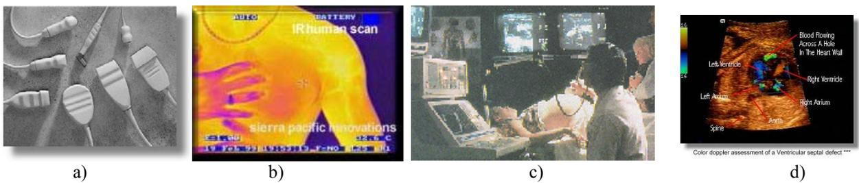
Figura 13. a) Diferentes tipos de sondas ferroelectricas de ultrasonidos para análisis y tratamiento. b) Imagen de infrarrojos del cuerpo humano. c) Sistema de ecografía ultrasónica. d) Imagen de flujo sanguíneo cerca del corazón mediante ecografía de efecto doppler.
