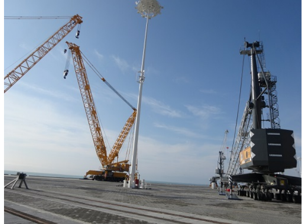
オープンスペースに並ぶクレーン (最大載荷重600tまでのクレーンが設置可能)
