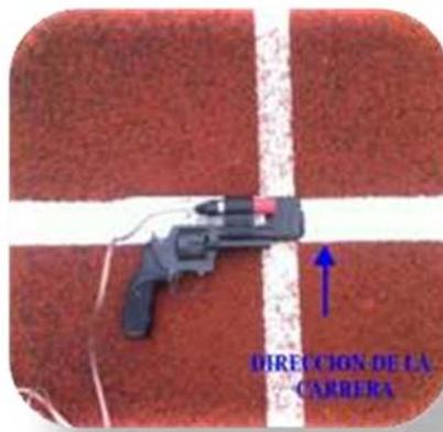
✓ Para la realización del control "0" **el sensor** (tester), debe situarse **junto a la pistola**, en un lugar próximo (5-10 cm), pero evitando que se pueda quemar. Incluso una distancia superior (sobre 20 cm, como muestran las fotografías), suele ser suficiente. Podemos también tener ya instalado el sensor en la pistola.
