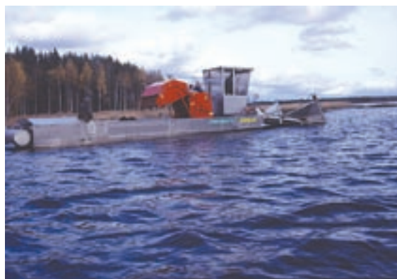
Vesisammalen poistoon käytetty työalus vaatii n. 70 cm:n vesisyvyyden, joten se ei sovellu mataliin lintuvesiin. Kuva: Tapio Aalto.
