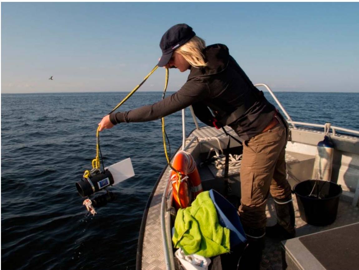
Kuva 15. Vedenalaisten elinympäristöjen laaja-alaiseen kartoitukseen kehitetty drop-videokamera lasketaan alas veteen lähelle pohjaa ja pohja-aluetta kuvataan noin 20 m 2 :n laajuiselta alalta. Kameran kuvaa seurataan ja hallitaan pintayksiköstä, jossa vedenalainen kuva näkyy tietokoneen monitorilla. Kuva: Maiju Lanki.
