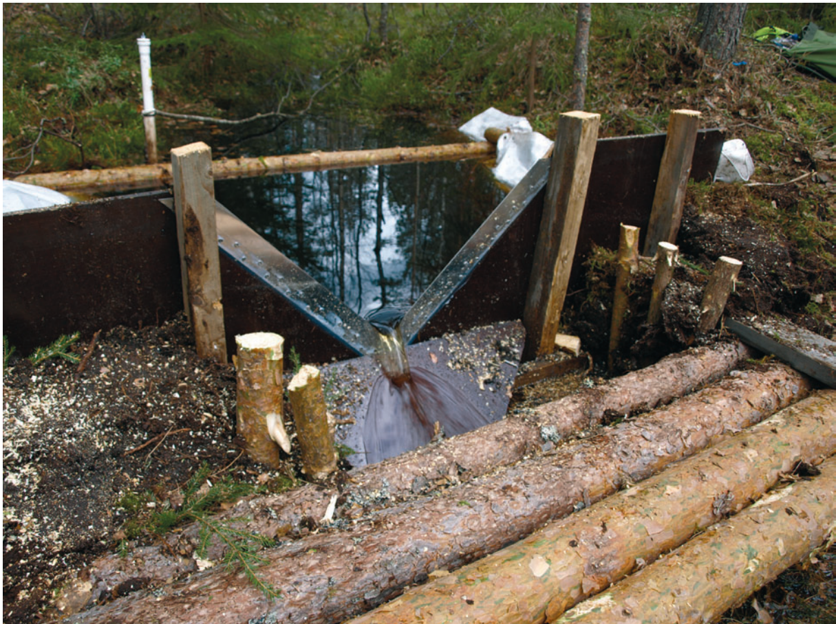
Kuva 15. Valumaseurannan mittapato Helvetinjärven kansallispuistossa Ruovedellä. Kuva: Teemu Tahvanainen.
