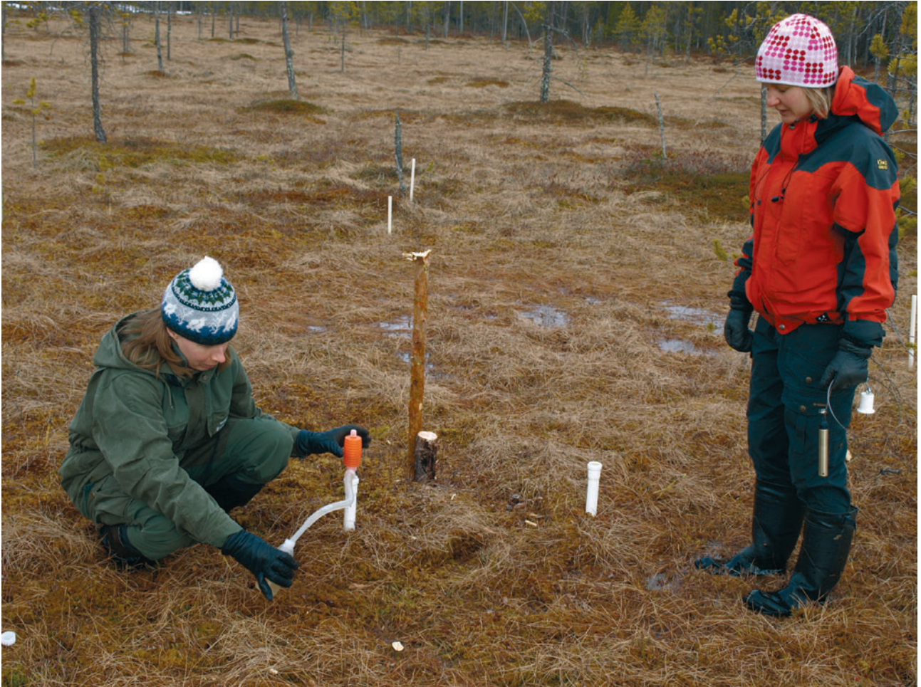
Vesinäytteen otto kasvillisuusseurantakohteen hydrologiselta havaintopisteeltä Mujejärven Natura 2000-alueella Nurmeksessa. Kuva: Teemu Tahvanainen.
