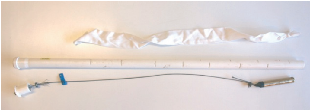
Kasvillisuusseurantakohteen hydrologisen havaintopisteen välineistöä. Keskellä on pöytäsiirkelillä viillostettu kaivo, yllmpänä kaivon ympärille pujotettava suodatinkankainen sukka ja alimpana Levelogger-mittari kiinnitysvaijereineen. Kuva: Teemu Tahvanainen.
