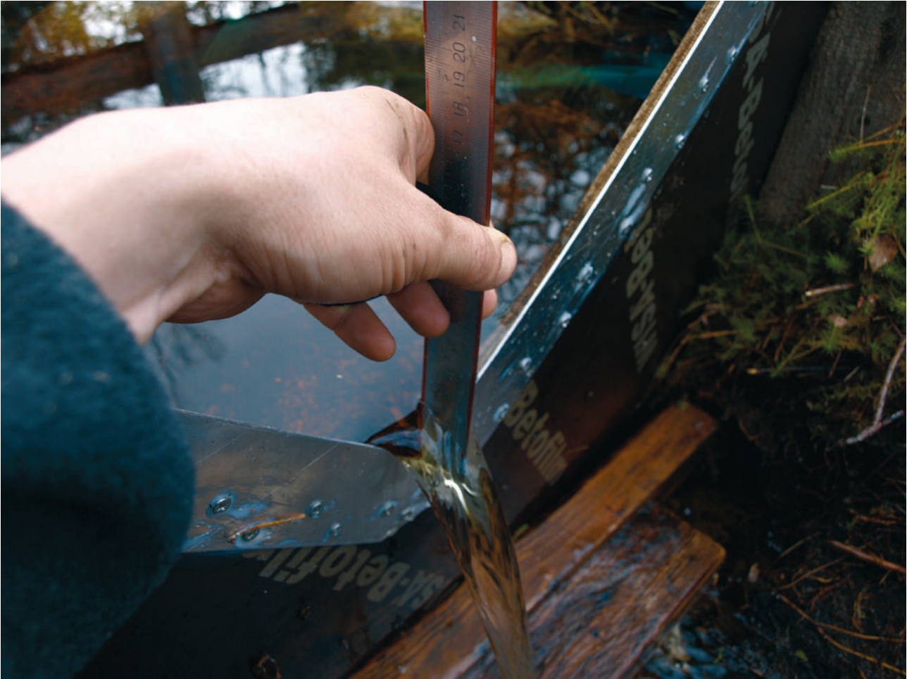
Veden korkeuden mittaaminen padon V-aukosta. Kuva: Teemu Tahvanainen.
