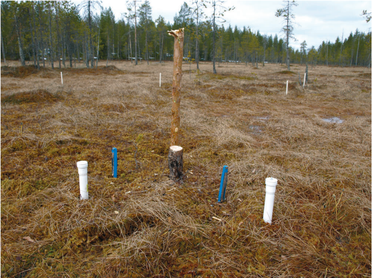
Kasvillisuusseurantakohteen hydrologinen havaintopiste Nurmeksessa Mujejärven Natura 2000 -alueella. Etu-alalla on kaksi valkoista kaivoa, joiden välissä on turpeeseen upotettu referenssipaalet ja sen merkkikeppi. Taka-alalla on valkoisia kasvillisuusruutujen merkkikeppejä. Kuva Teemu Tahvanainen.
