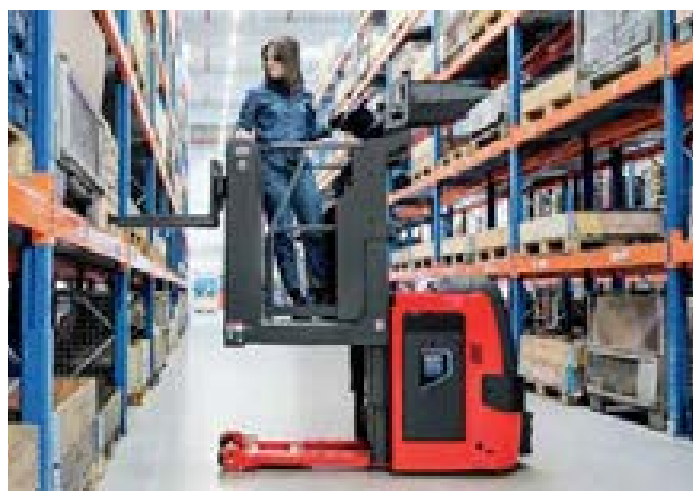
Abb.: Der Zusatzhub beim Linde V08-02 ermöglicht es, die Gabelzinken unabhängig vom Fahrerstand anzuheben.
