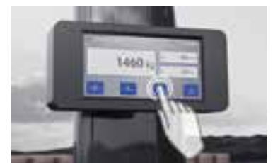
Abb.: SmartFork® Scale Display mit Lastschwerpunkt-Anzeige
