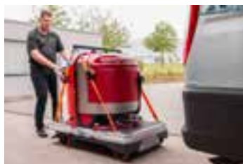
Die Last mit Gurten auf xetto® verzurren. xetto® vor dem Fahrzeug positionieren.
