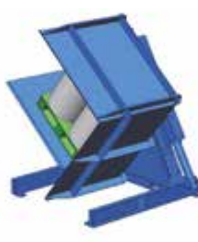
Gebinde klemmen und Einheit um 180° schwenken
