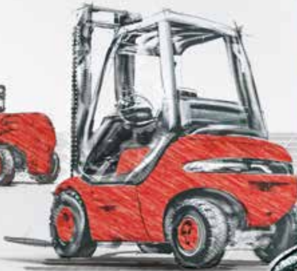
Abb.: Hubtrac (links), Baureihe 351 (Mitte), Linde-Gegengewichtsstapler H35. Der hydrostatische Antrieb legte den Grundstein für den Erfolg der Linde-Stapler.
