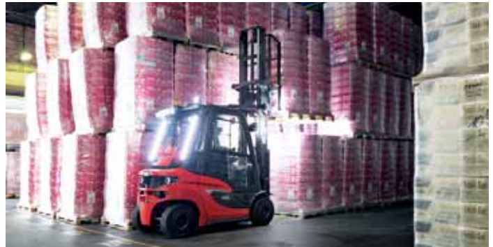
Abb.: Gerade beim Be- und Entladen unter schlechten Lichtverhältnissen sorgen das VertiLight™ sowie die LED-Lichtleisten für eine gleichmäßige Ausleuchtung ohne Blendeffekt.
