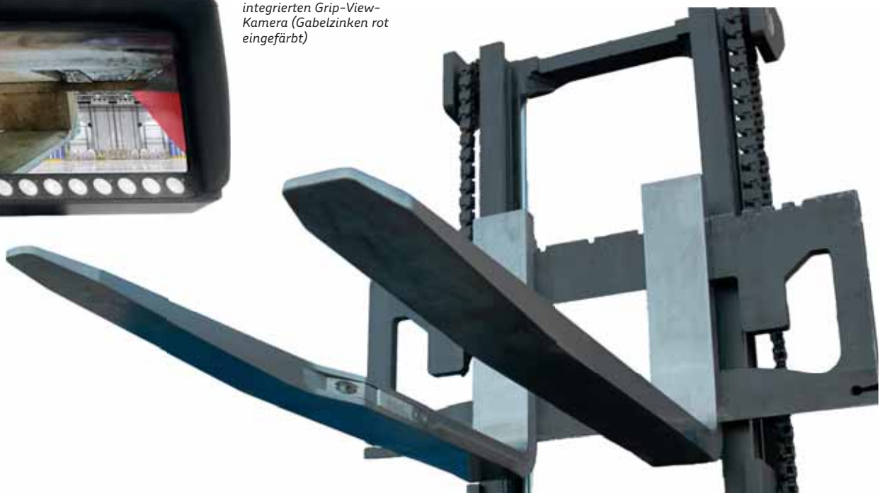
Abb.: Eingeschränkte Sicht mit angebauter Kamera. Marktstandard (Gabelzinken rot eingefärbt)
