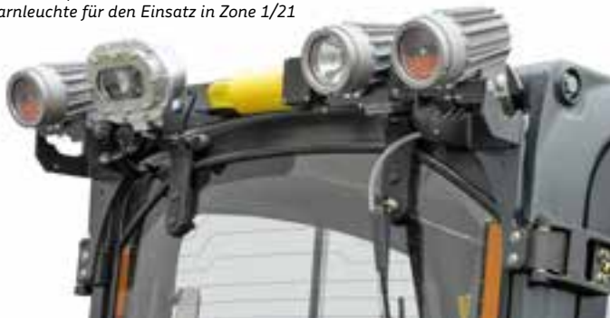
Abb.: BlueSpot, Blinker und Warnleuchte für den Einsatz in Zone 1/21
