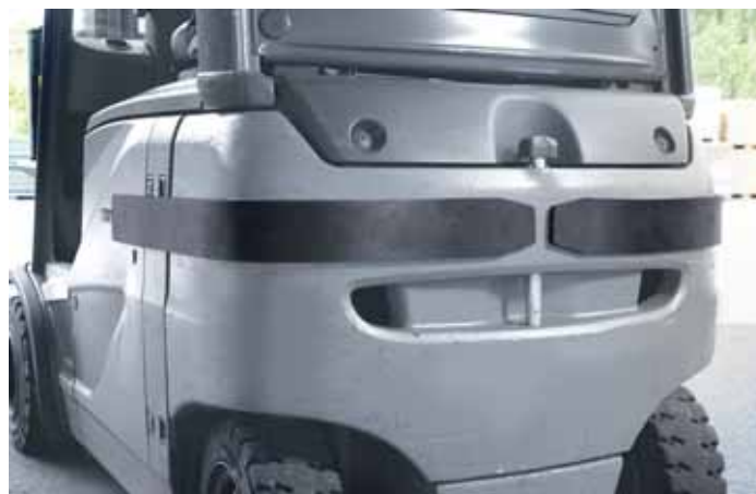
Abb.: Auch als Rammschutz für das Stapler-Chassis verwendbar
