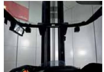
Abb.: Gleichmäßige, blendfreie Ausleuchtung mit VertiLight™
