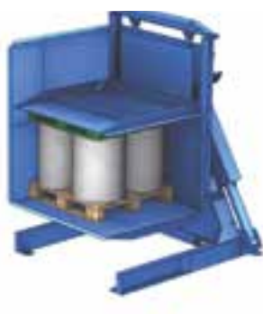
Auf das Gebinde eine neue Palette (z.B. Kunststoff) legen
