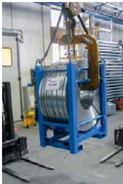
Abb.: vielfältige Transportmöglichkeiten → Staplertaschen an der Schmal- und Breitseite des Behälters → 4 Kranösen an den Behälterecken → Direkte Aufnahme des Coils (Behälter kann mitgehoben werden)
