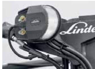
Abb.: Gerade beim Be- und Entladen unter schlechten Lichtverhältnissen sorgen das VertiLight™ sowie die LED-Lichtleisten für eine gleichmäßige Ausleuchtung ohne Blendeffekt.
