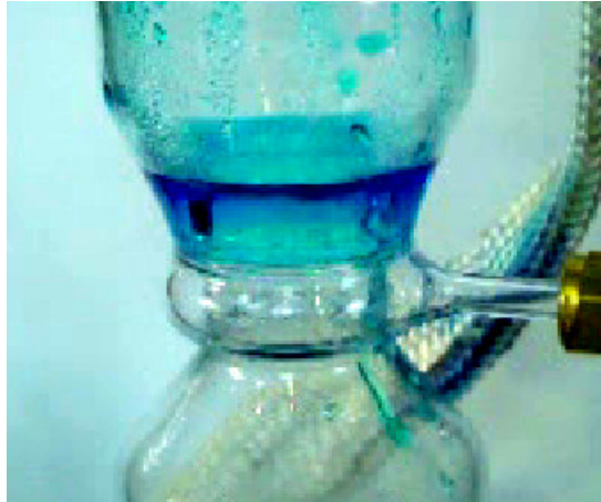
Abb. 5.17: Abscheider des Destillationsrückstandes im ATR-8Qg. Wasser mit Methylenblau als Modellstoff für Diesel.
