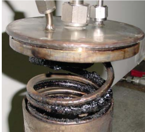
Abb. 2.25: Rohrwendel des Reaktors ATR-5A mit kohlenstoffhaltigen Ablagerungen nach dem Betrieb mit Aral Ultimate .
