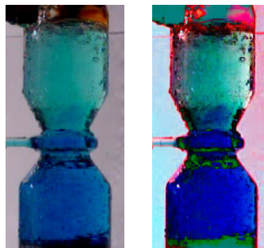
Abb. 5.23: Strömung im ATR-7Qg mit gefärbtem „Luftstrom“. In realen (links) und digital bearbeiteten (rechts) Farben.
