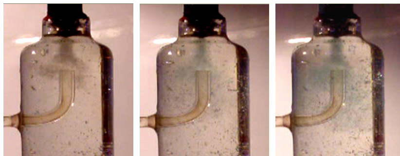
Abb. 5.19: Strömung im ATR-5Qg mit gefärbtem „Luftstrom“. Dieses Modell entspricht dem Fall, wenn die gesamte Luftmenge durch die Zweistoffdüse strömt. Die Fotos wurden mit einem zeitlichen Abstand von 1/25 s aufgenommen.
