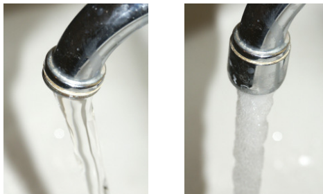
Abb. 4.35: Wirkung der Einbauten auf die Strömungshomogenisierung. Freier Strom (links) und Wasserstrom mit Luft in einem Perlator gemischt und homogenisiert (rechts).
