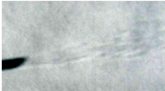
Abb. 5.3: Heliumstrom in der Luftumgebung, Schattenbild mit Sonnenlicht
