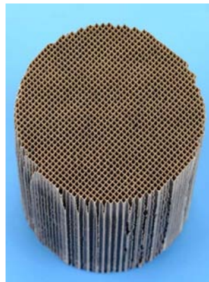
Abb. 4.1 Keramischer Monolith mit einer Zelldichte von 600 cpsi beschichtet mit einem Edelmetallkatalysator von Umicore AG & Co. KG
