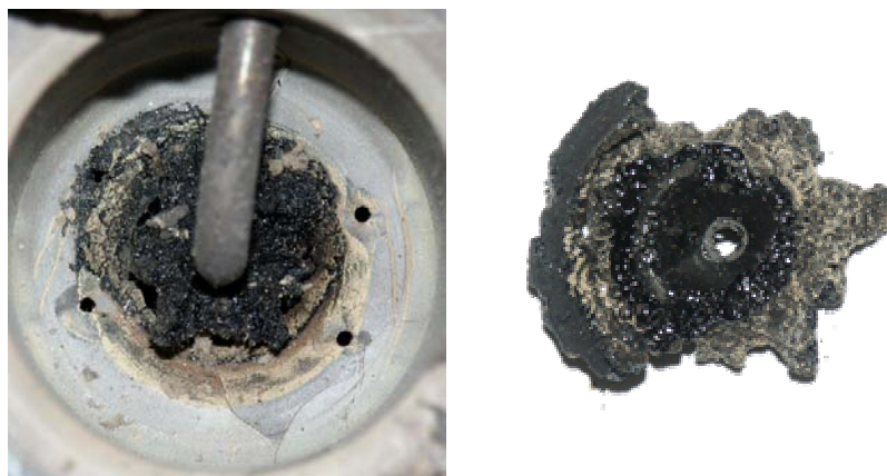
Abb. 2.22: Links: Ablagerungen in der Mischkammer des Reaktors ATR-5A nach dem Betrieb mit Aral Artik Diesel. Rechts: Ablagerungen nach der Entfernung von der Düse.
