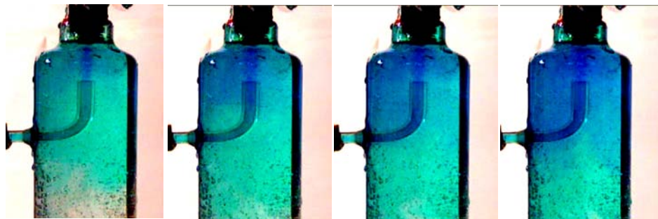
Abb. 5.20: Strömung im ATR-5Qg mit gefärbtem „Dampfstrom“, entsprechend der Luftaufteilung über dem Strang der Zweistoffdüse für 50 % des gesamten Luftstroms. Die Fotos wurden mit einem zeitlichen Abstand von 1/5 s aufgenommen.
