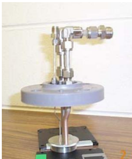
Abb. 2.17: Dreistoffdüse von Argonne National Laboratory /56/
