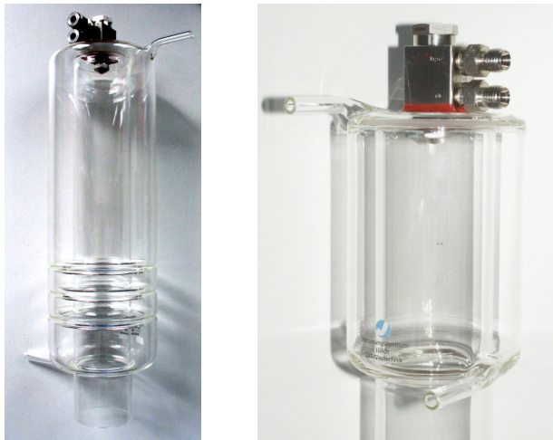
Abb. 5.6: Glasreaktoren für Sprühbilduntersuchungen der Zweistoffdüse Mod. 970; Version 1 (links) und Version 2 (rechts)
