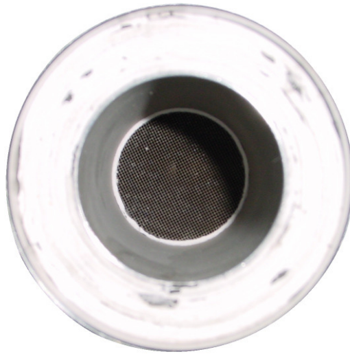
Abb. 4.37: Einbau des mit Katalysator beschichteten Monolithen im autothermen Reformer ATR-4
