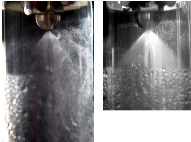
Abb. 5.9: Sprühbild der Einstoffdüse im Glasreaktor bei 700 g/h Wasser; Momentaufnahme (links) und fotografische Überlagerung von 378 Momentaufnahmen zur Bestimmung eines gemittelten Strömungsbildes (rechts)
