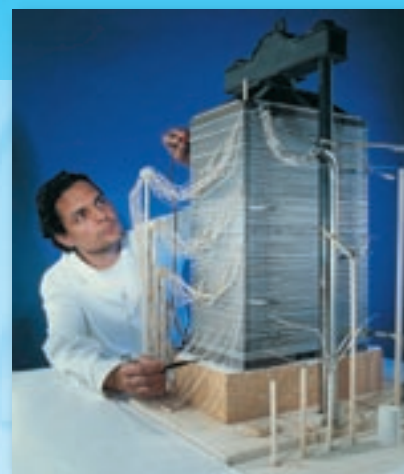
SOFC-Brennstoffzellen-Stapel 60 Zellen, Gesamtleistung 13,6 kW bei Einsatz von H 2 und einer Arbeitstemperatur von 800 °C (Helmholtz-Zentrum Jülich)
