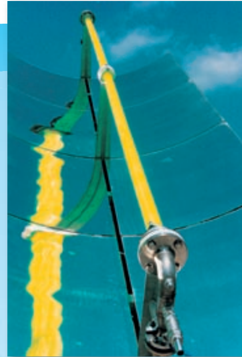
CSP-Anlage (DLR): In diesem Fall konzentrieren die Spiegel die Sonnenenergie auf Rohre, in denen eine Flüssigkeit hoch erhitzt wird.
