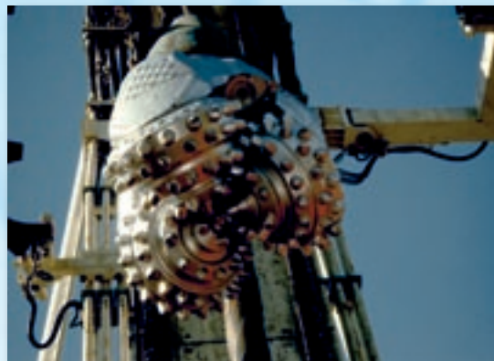
Bohrmeißel einer Geothermie-Tiefbohrung
