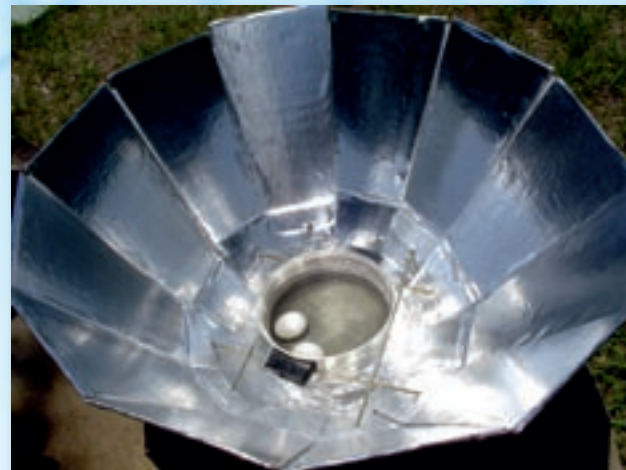
Ein Solarkocher. Hier ein Modell zum Selbstbauen aus Pappe und Alufolie.
