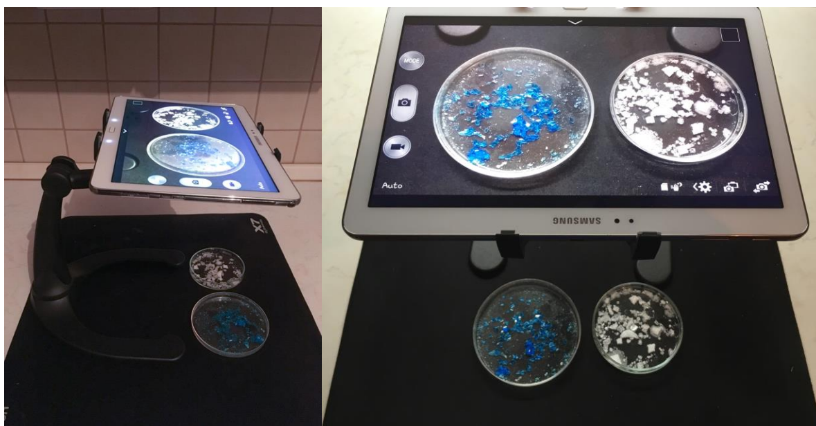
Obr. 4. Použití tabletu jako vizualizéru. Vizualizér je ideální na zobrazení malých předmětů jako jsou krystaly, nebo experimenty s povrchovým napětím.
