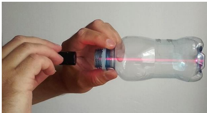
Obr. 2a, 2b. Zviditelnění paprsku v kouři
