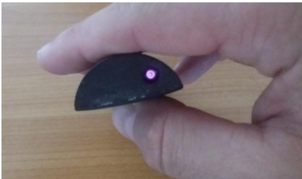
Obr. 3. Snímek svící IR LED diody v dálkovém ovladači.
