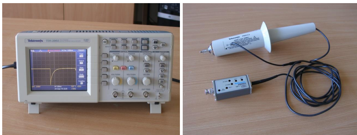
Obr. 1. Osciloskop a vysokonapěťová sonda
