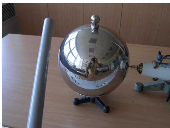
Obr. 7. Přeskok náboje do velké kovové koule přiložené k hrotu sondy
