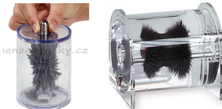
Obr. 2. Detekční nádoby na „3D“ zkoumání magnetického pole
