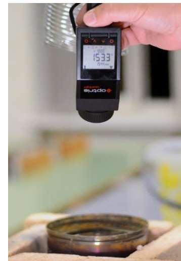
Obr. 5. Údaj infračerveného teploměru pro olovo o teplotě dle obr. 4
