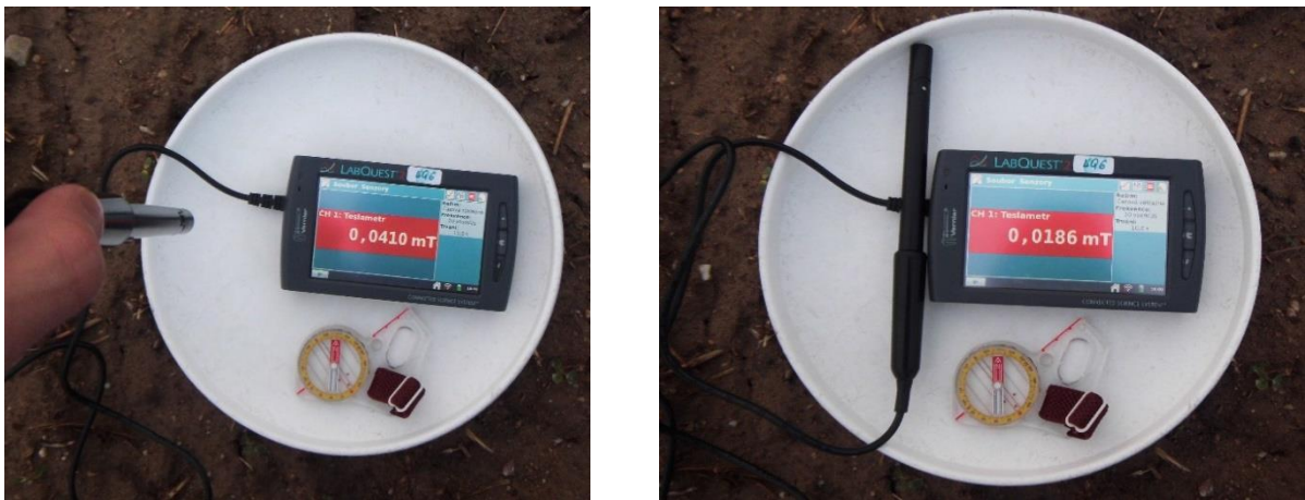
Obr. 4. Měření vertikální složky magnetické indukce (vlevo) a horizontální složky magnetické indukce (vpravo) teslametrem Vernier. Vpravo má sonda směr magnetického poledníku.
