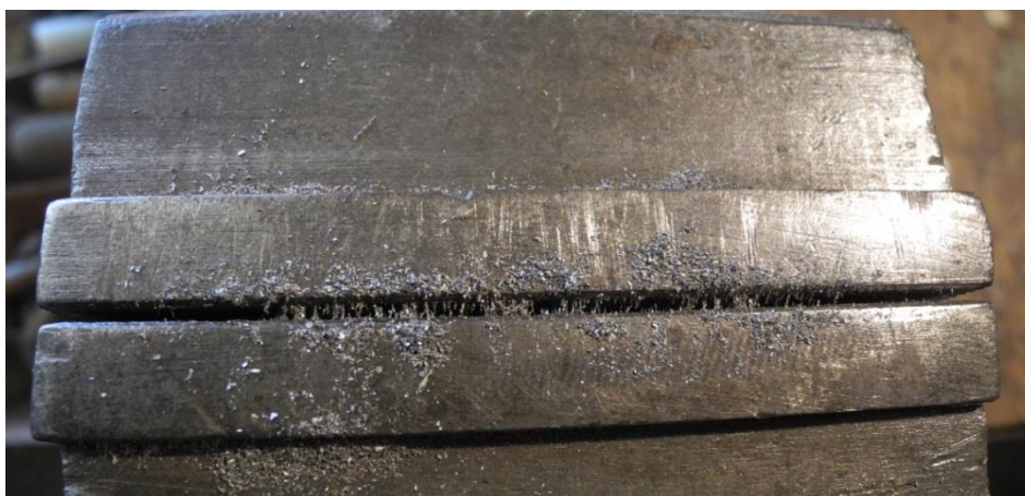
Obr. 1. Železné piliny na čelistech svěráku.
