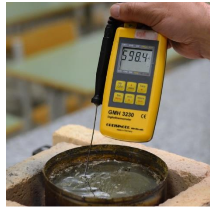
Obr. 4. Teplota olova měřená ponorným teploměrem
