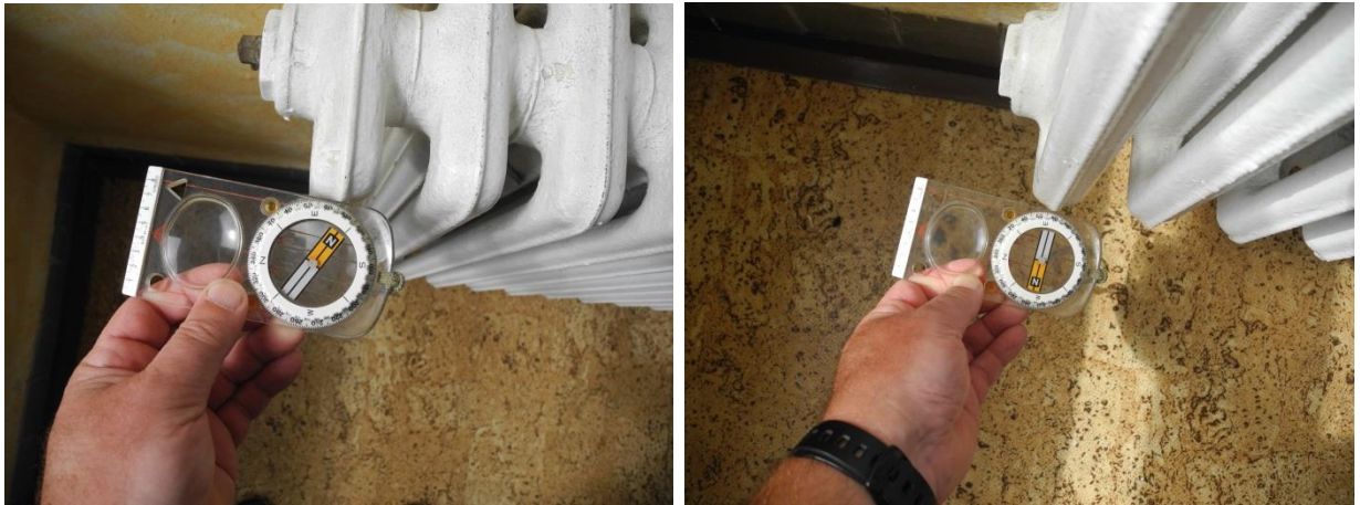
Obr. 2. Střelka buzoly se nahoře u radiátoru přitahuje severním koncem (vlevo) a dole jižním koncem (vpravo).
