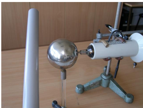
Obr. 6. Přeskok náboje do kovové koule přiložené k hrotu sondy
