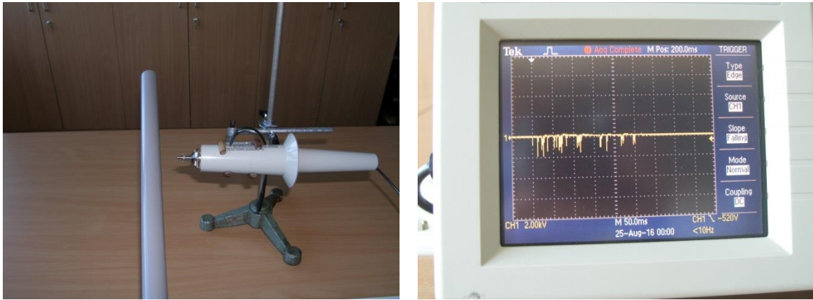
Obr. 3. Sršení náboje z nabitě novodurové tyče do hrotu sondy
