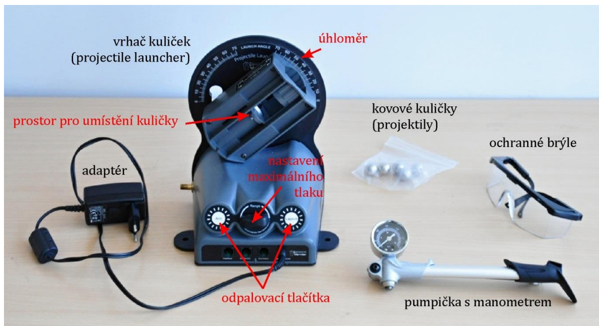
Obr. 4. Aparatura k aktivitě „střílíme z kanónu“. Navíc je třeba: metr, krabička, milimetrový papír, psací a rýsovací potřeby.
