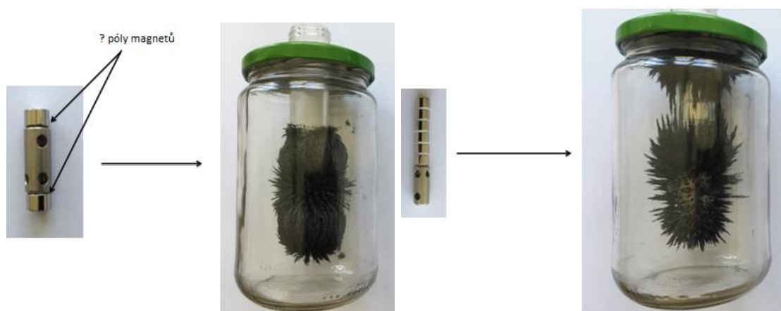
Obr. 5. Vlevo dva magnety souhlasnými póly k sobě a mezi nimi železný váleček. Vpravo železný váleček připojený k válcovému magnetu.
