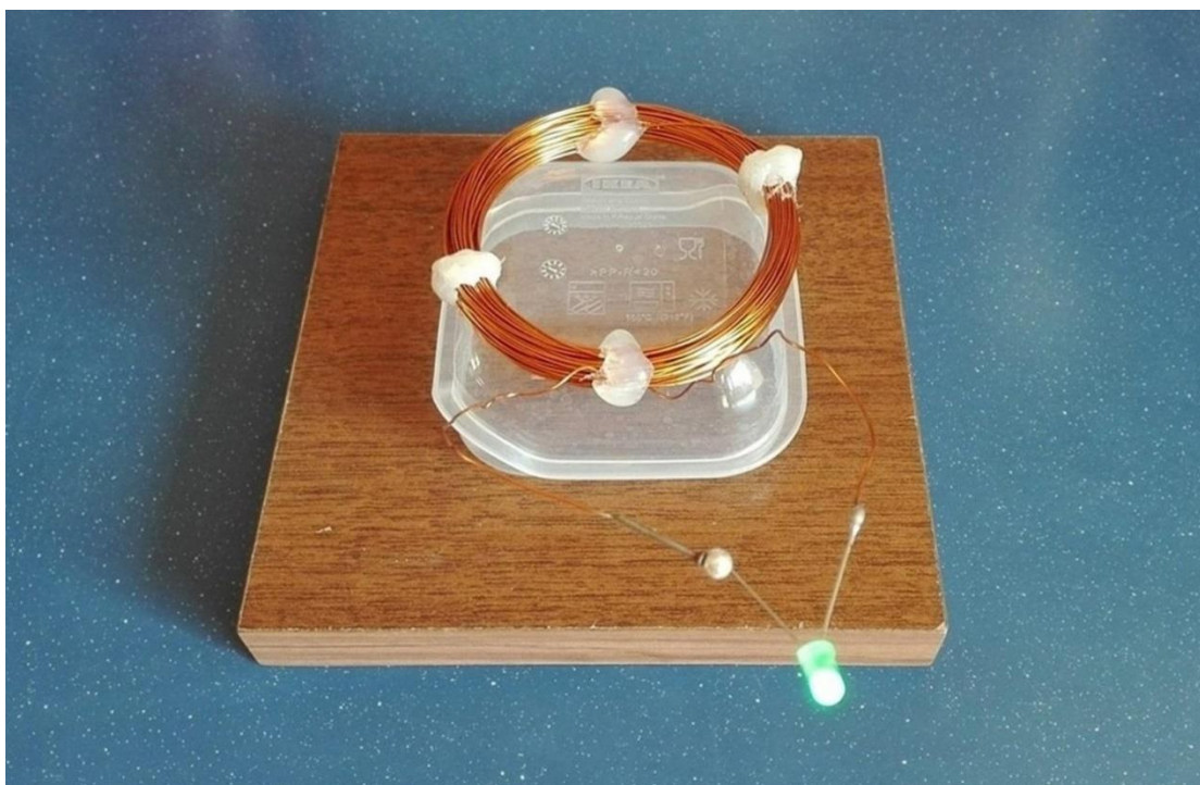
Obr. 8. Cívka s připojenou LED
